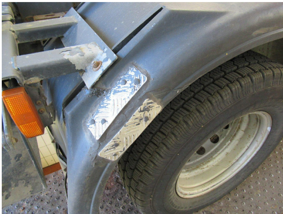
Bild 17 : Kotflügel hr gerissen ( Provisorisch Instandgesetzt )
