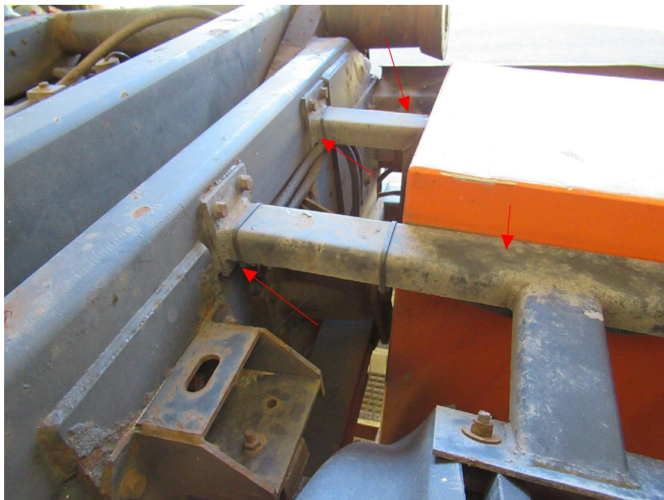
Bild 18 : Halter Staukasten verbogen
