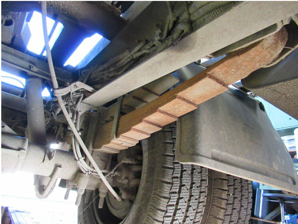
Bild 13 : Hinterachse verrostet ( Gebrauchsschaden )
