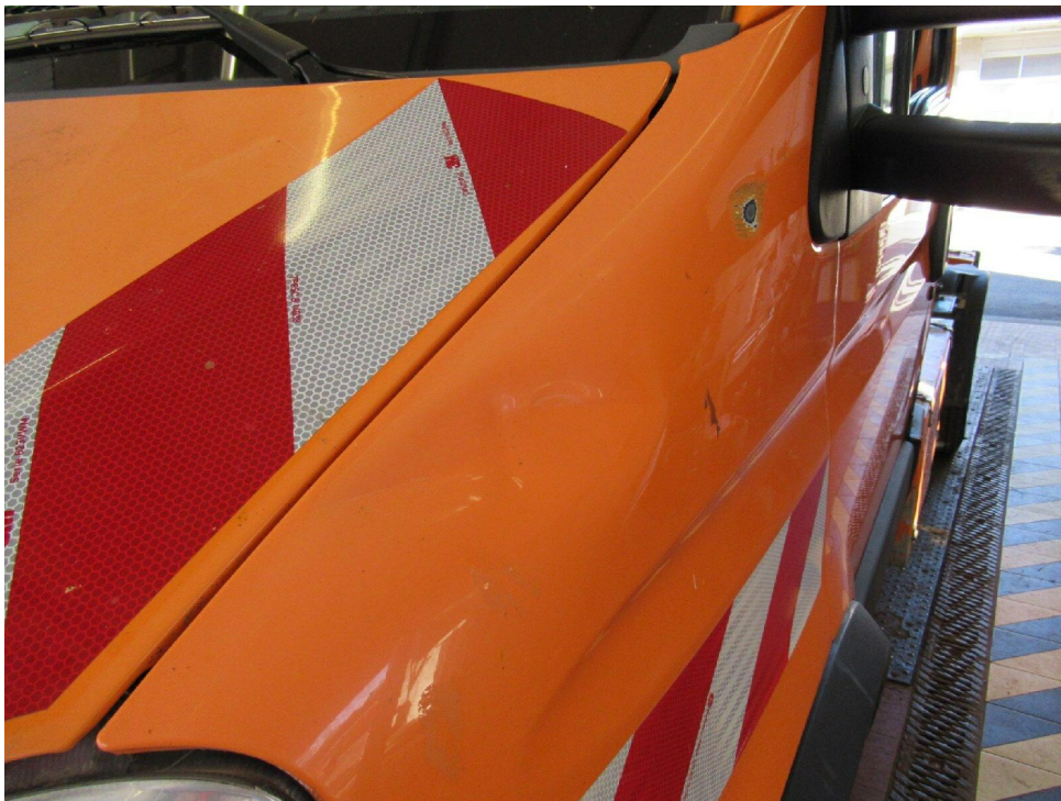
Bild 10 : Kotflügel vl eingedellt
