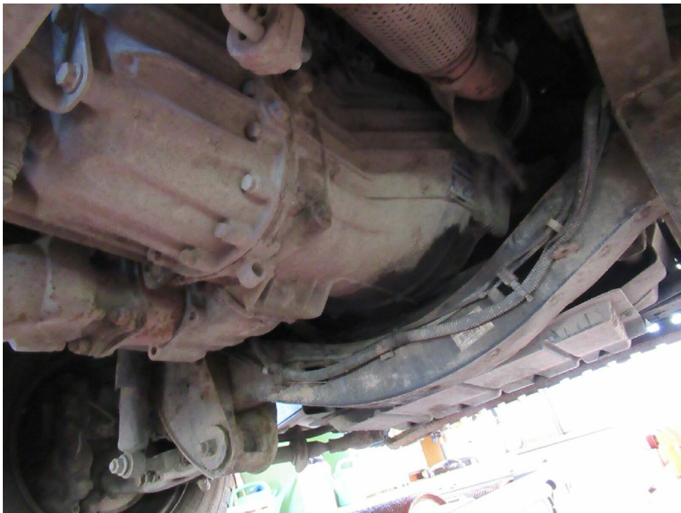
Bild 12 : Getriebe ( Gang springt unter Last raus )
