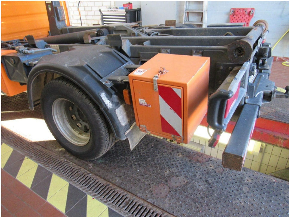
Bild 19 : Halter Staukasten verbogen
