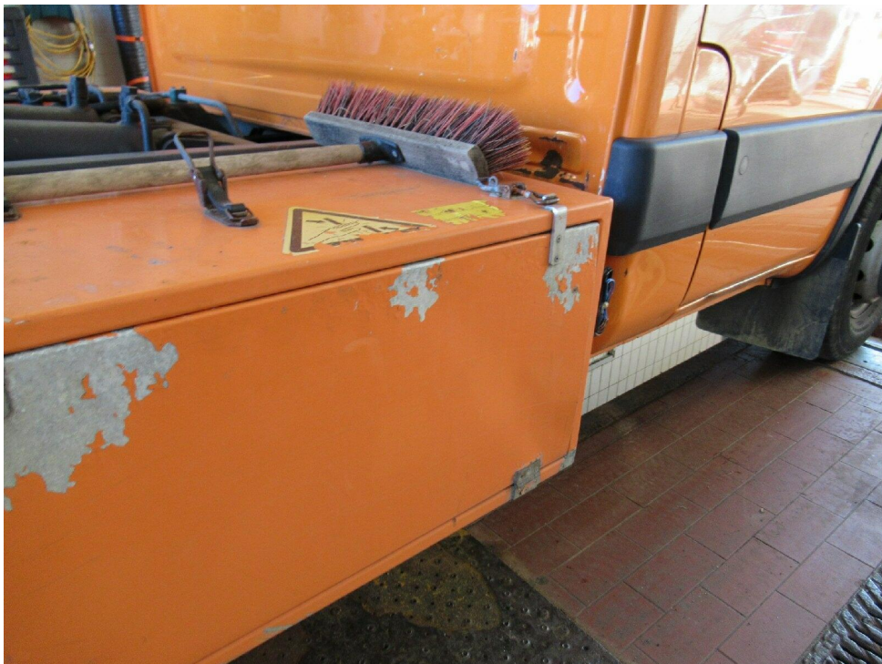
Bild 14 : Schweller eingedellt, Staukasten Lackschäden
