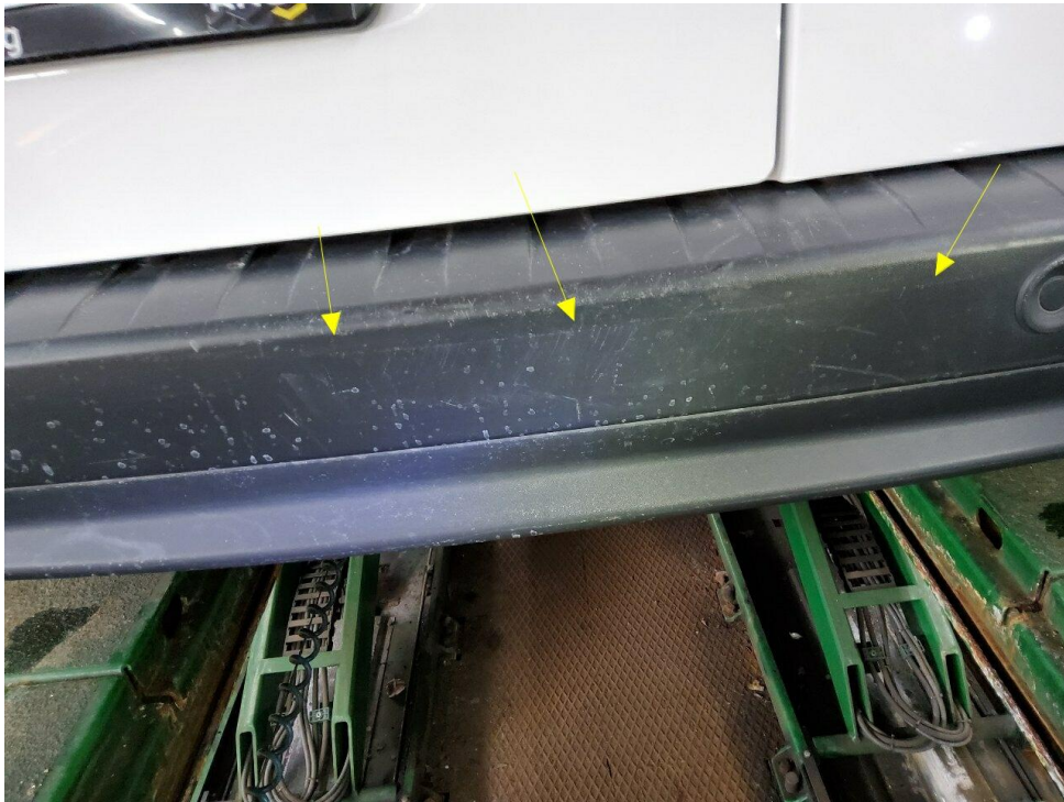
Bild 7 : Stoßfänger hinten, deformiert, erneuern
