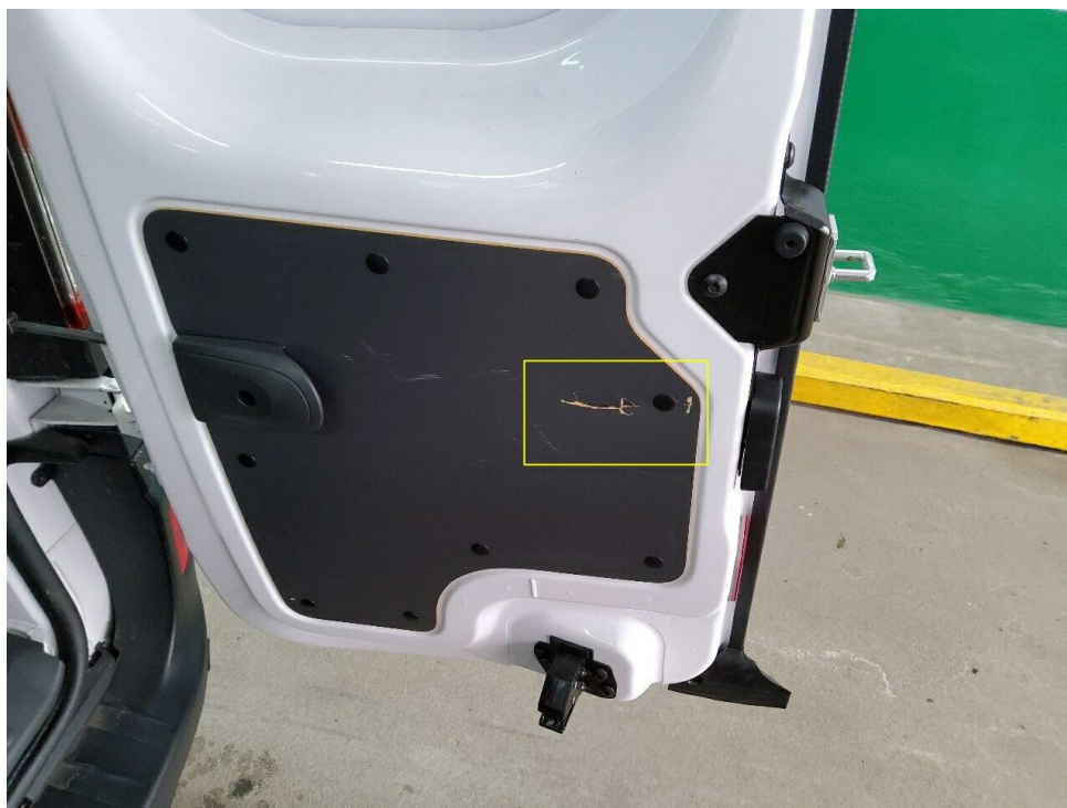
Bild 12 : Hecktür hinten rechts Türverkleidung gebrochen
