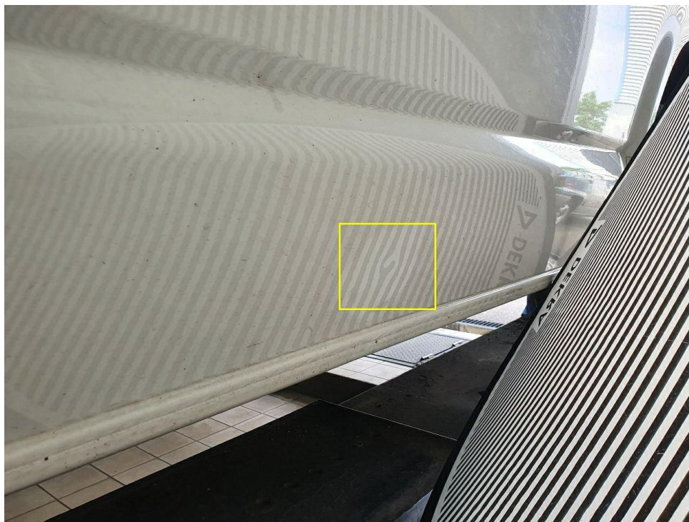
Bild 26 : Seitenwand links mehrfach eingedellt
