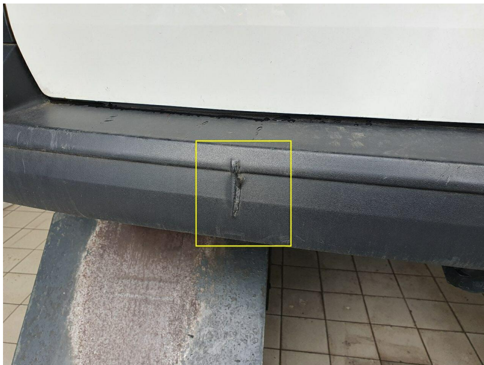
Bild 27 : Stoßfänger hinten gestaucht, eingeschnitten
