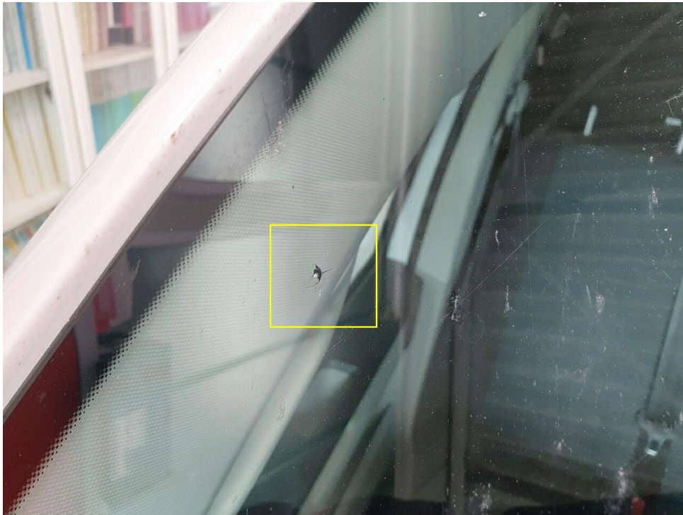
Bild 7 : Frontscheibe mehrere Steinschläge
