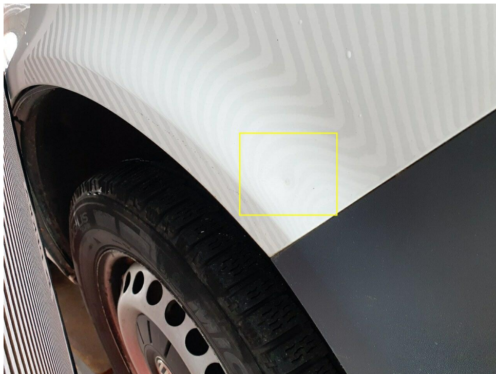
Bild 31 : Kotflügel vorne rechts eingedellt
