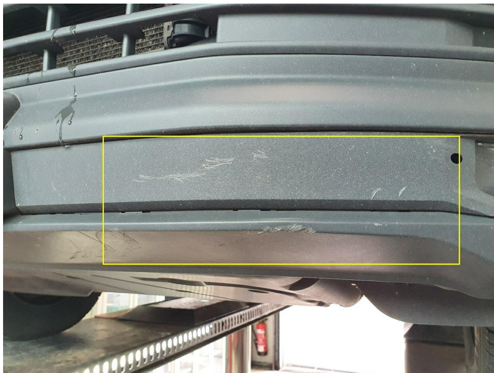
Bild 33 : Stoßfänger vorne mehrfach verschrammt
