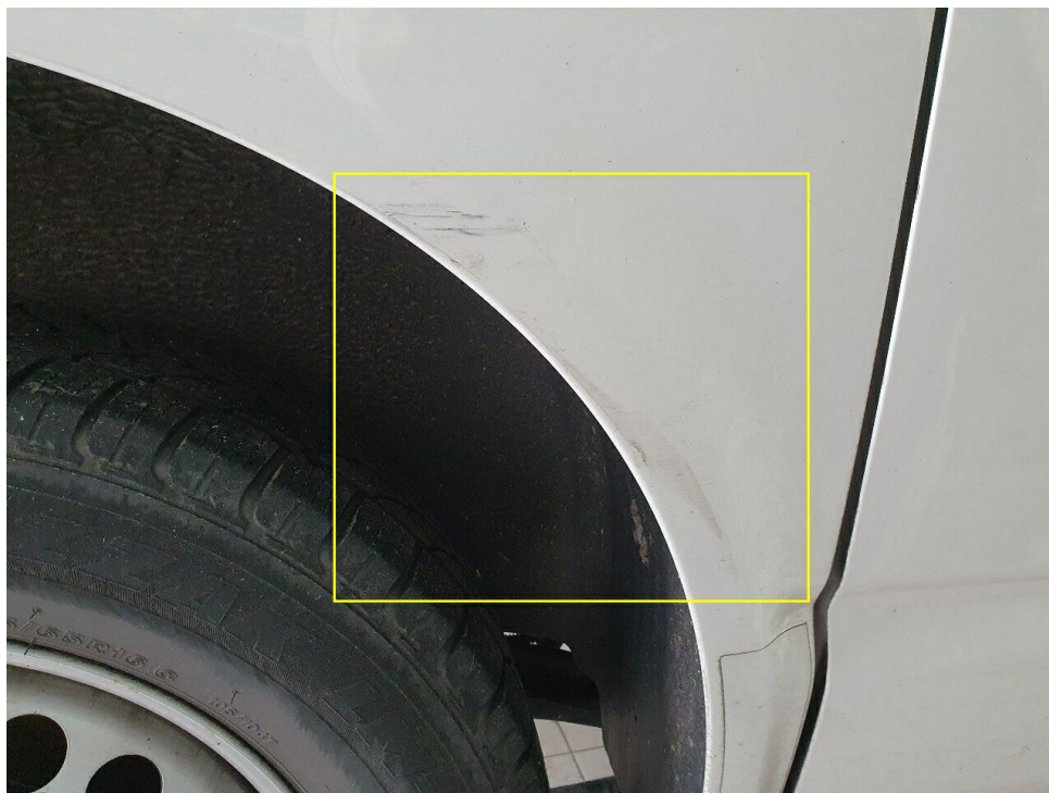
Bild 21 : Seitenwand hinten rechts verkratzt
