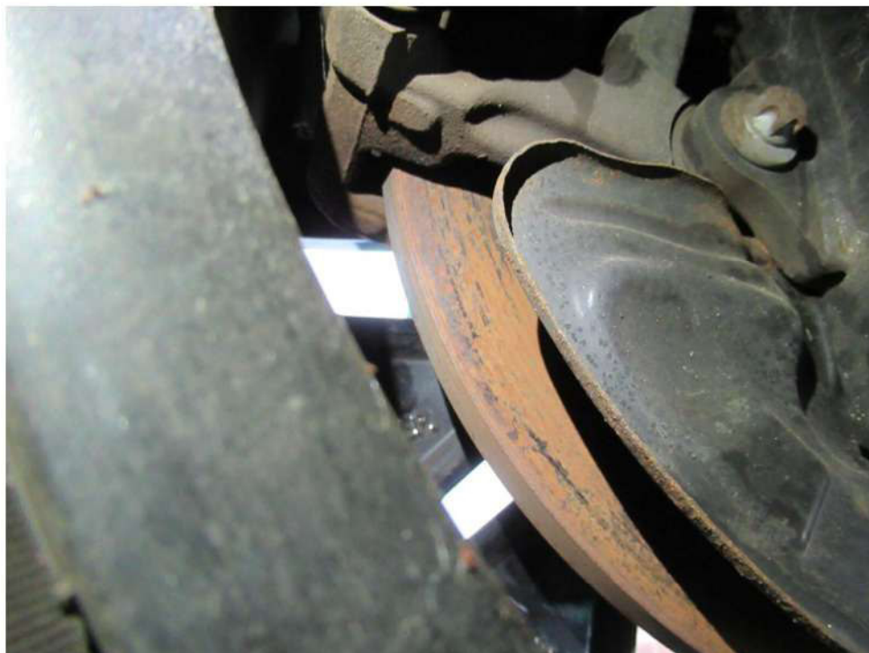
Bild 14 : - Bremsscheiben Tragbild Korrosion (Standzeit)
