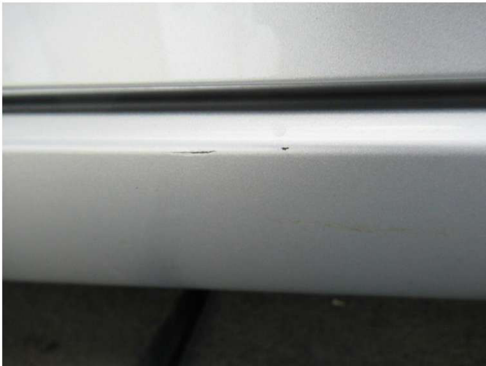
Bild 12 : - Schwellerverkleidung rechts verschrammt
