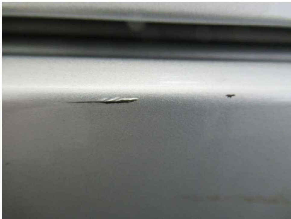
Bild 13 : - Schwellerverkleidung rechts verschrammt
