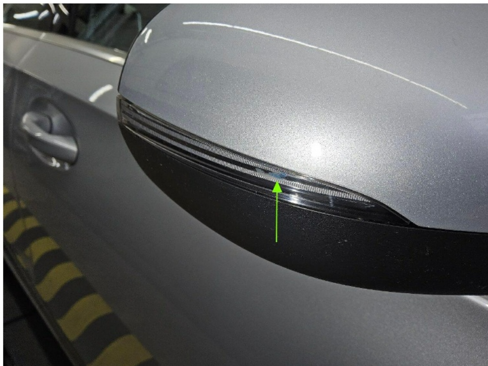
Bild 10 : Außenspiegelblinker rechts verschrammt
