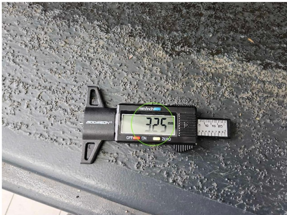
Bild 12 : Winterbereifung der Vorderachse <4mm Profiltiefe
