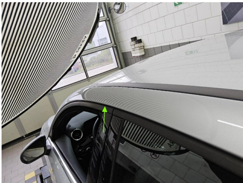
Bild 8 : Dachholm links eingedellt
