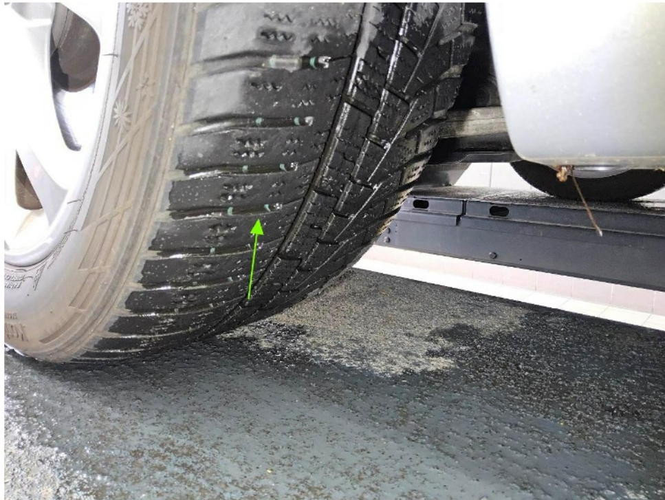
Bild 11 : Winterbereifung der Vorderachse <4mm Profiltiefe
