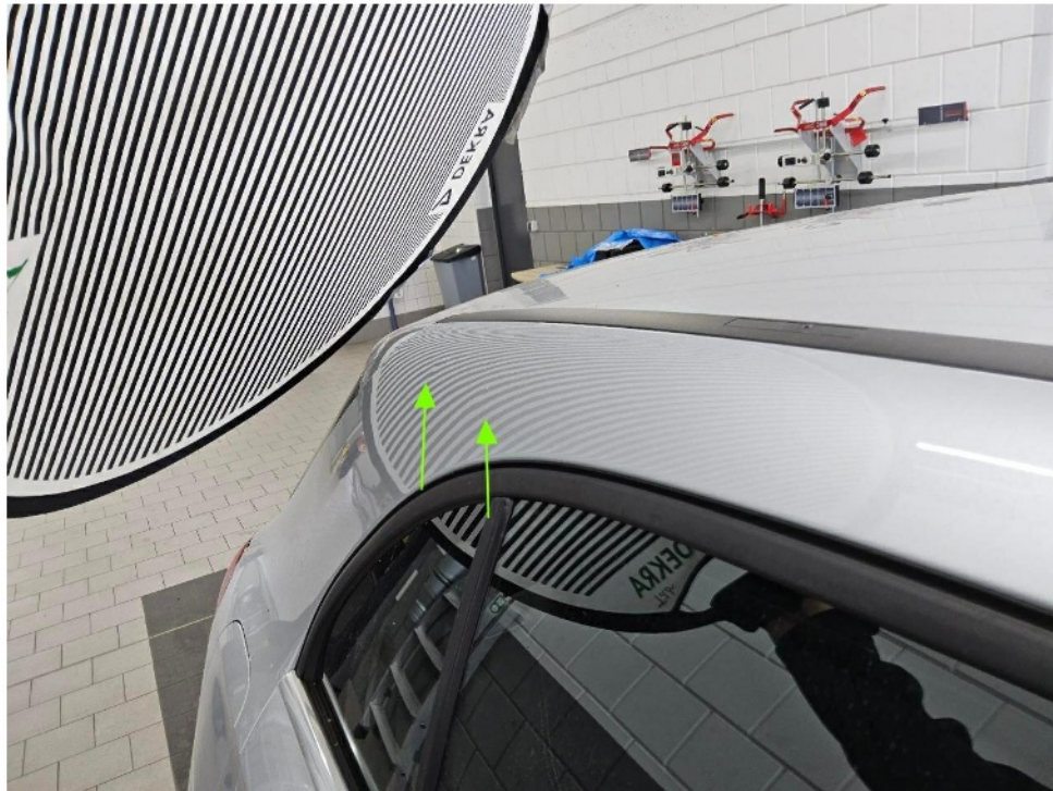
Bild 9 : Dachholm rechts mehrfach eingedellt
