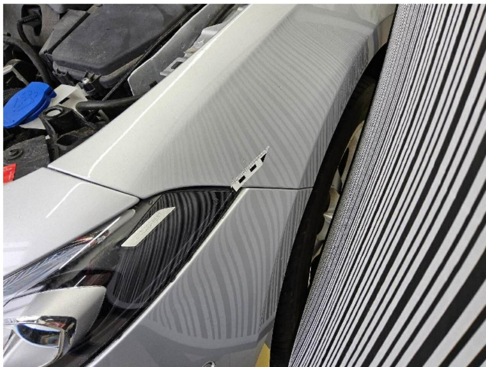
Bild 7 : Kotflügel vorn links bis auf das Grundmaterial verschrammt und eingedellt
