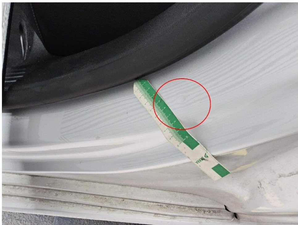
Bild 13 : Einstiegsleiste hinten links punktuell eingedellt
