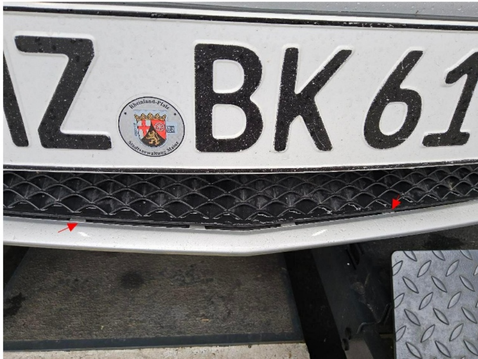
Bild 9 : Untere Grillverkleidung mangelhafte Befestigung
