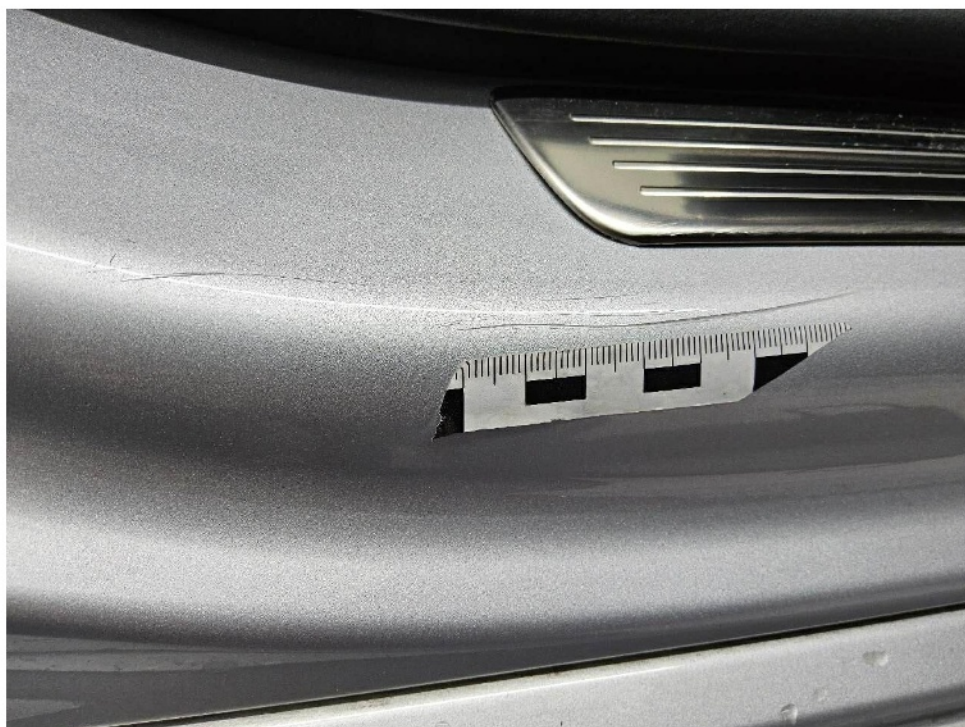
Bild 12 : Einstieg vorn rechts bis auf das Grundmaterial verschrammt
