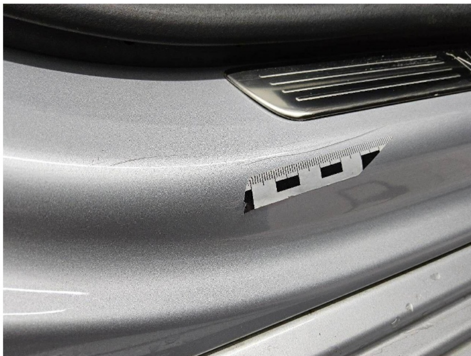
Bild 11 : Einstieg vorn rechts bis auf das Grundmaterial verschrammt
