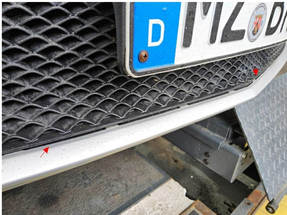
Bild 10 : Untere Grillverkleidung mangelhafte Befestigung
