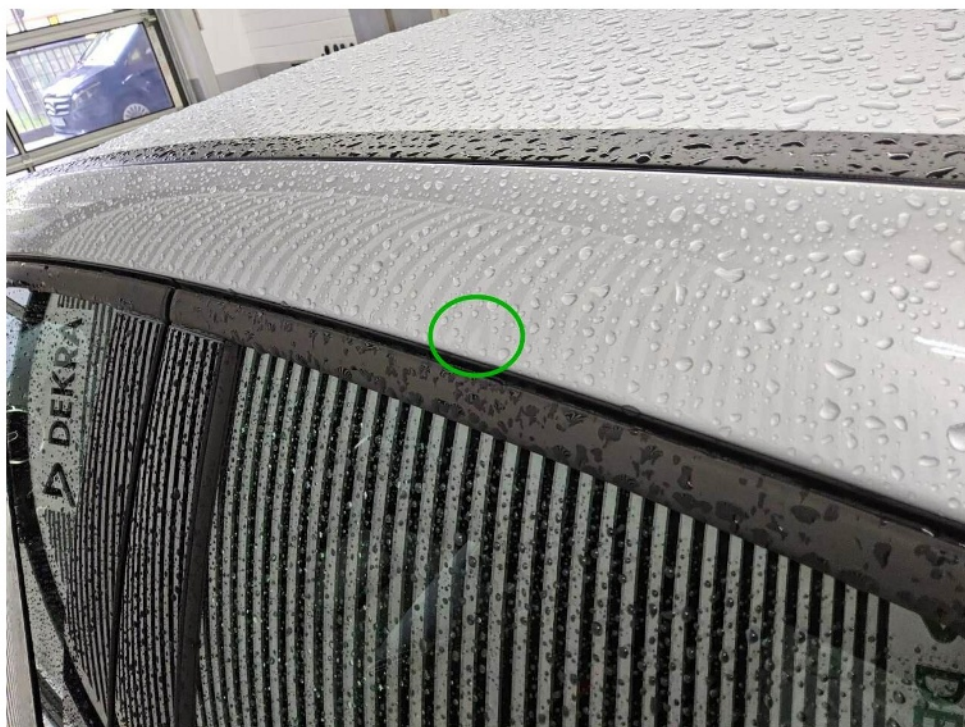
Bild 8 : Dachrahmen links, eingedellt, smart repair
