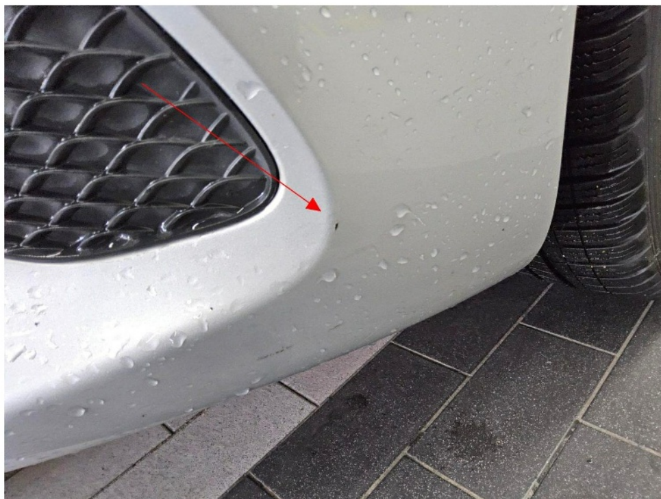
Bild 7 : Stoßfänger vorne Lackierung, zerkratzt, lackieren
