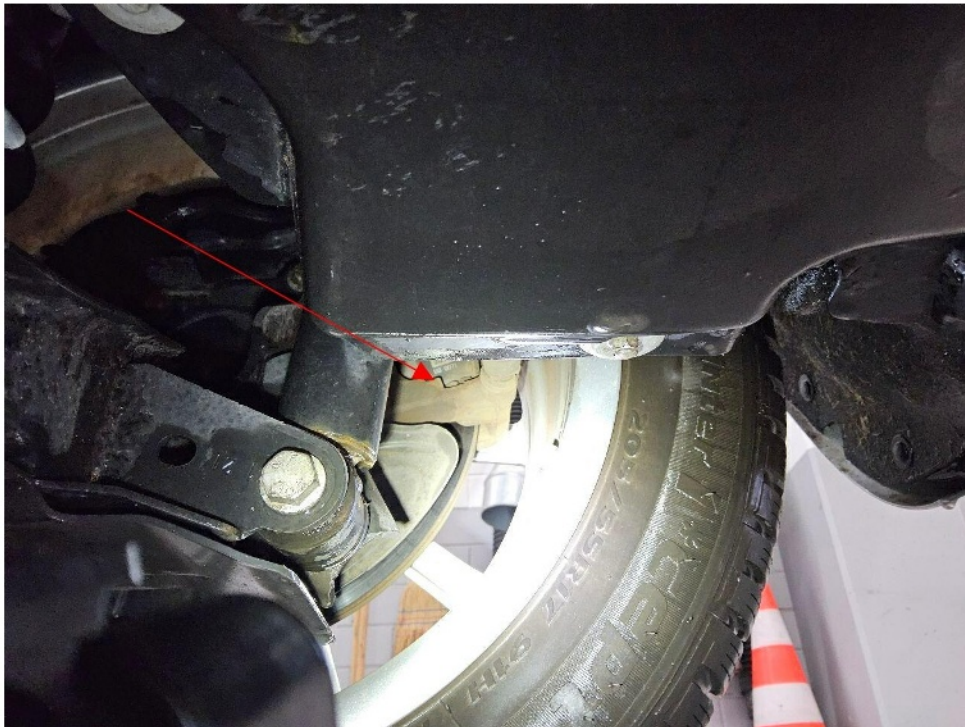
Bild 9 : Bremsbeläge hinten an Verschleißgrenze
