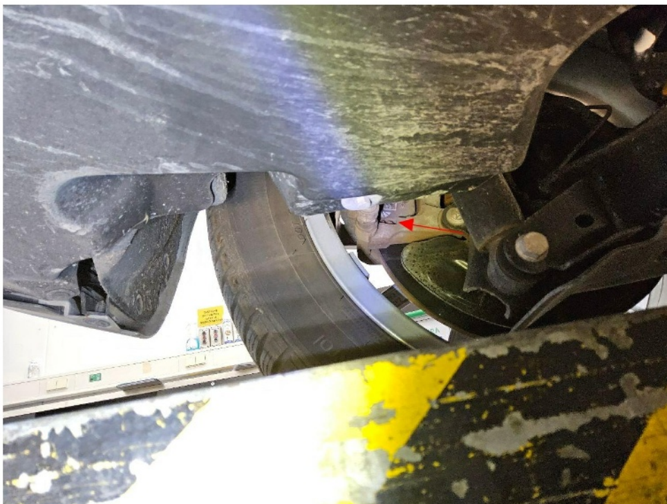
Bild 8 : Bremsbeläge hinten abgefahren
