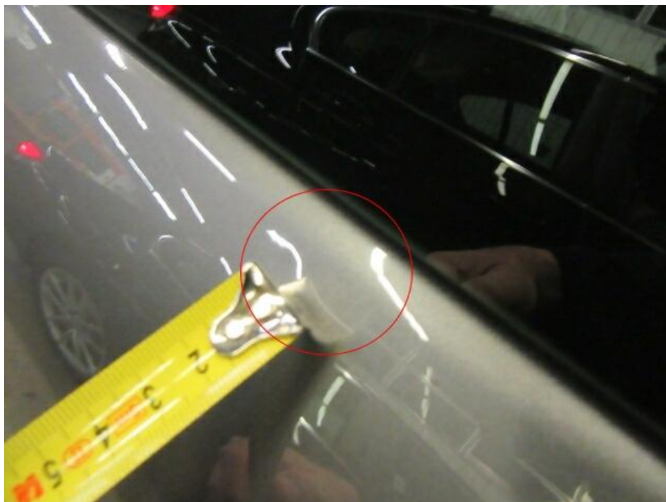
Bild 14 : Tür HR: eingedellt
