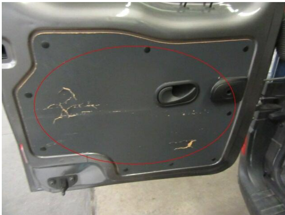
Bild 9 : Flügeltürverkleidung HL+HR beschädigt
