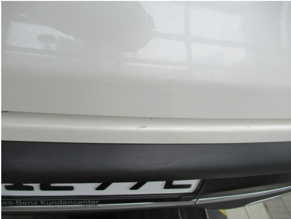
Bild 5 : Stoßfänger hinten Lackkratzer
