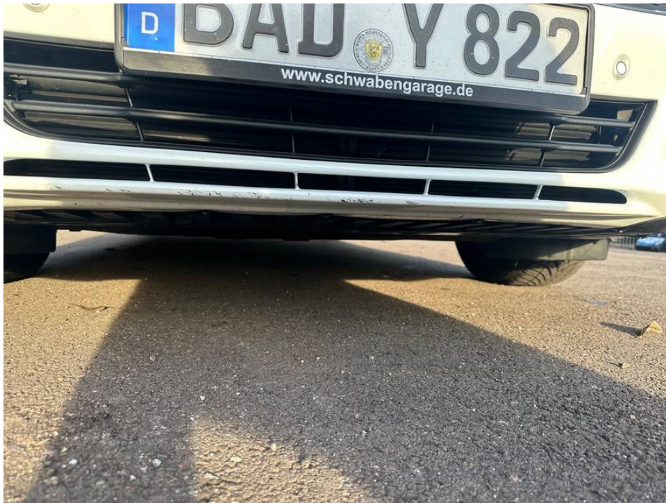
Lackkratzer Stoßfänger vorne unterhalb
