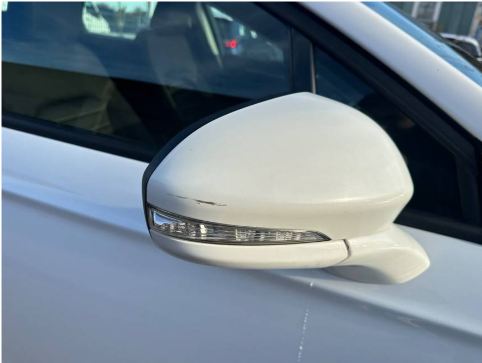
Lackkratzer Außenspiegel rechts
