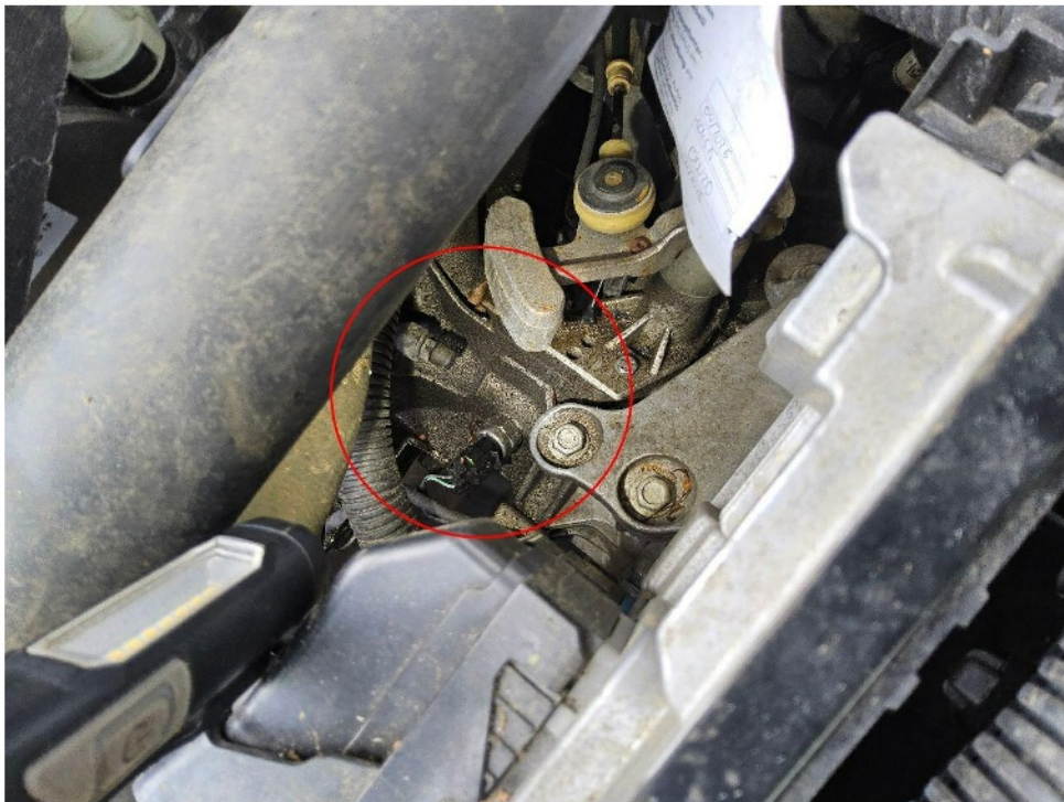
Bild 8 : Undichtigkeit im Bereich Getriebe
