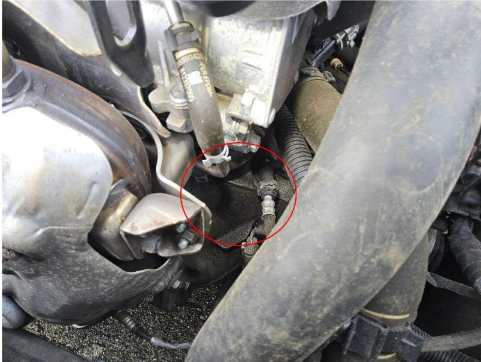
Bild 9 : Undichtigkeit im Bereich Getriebe
