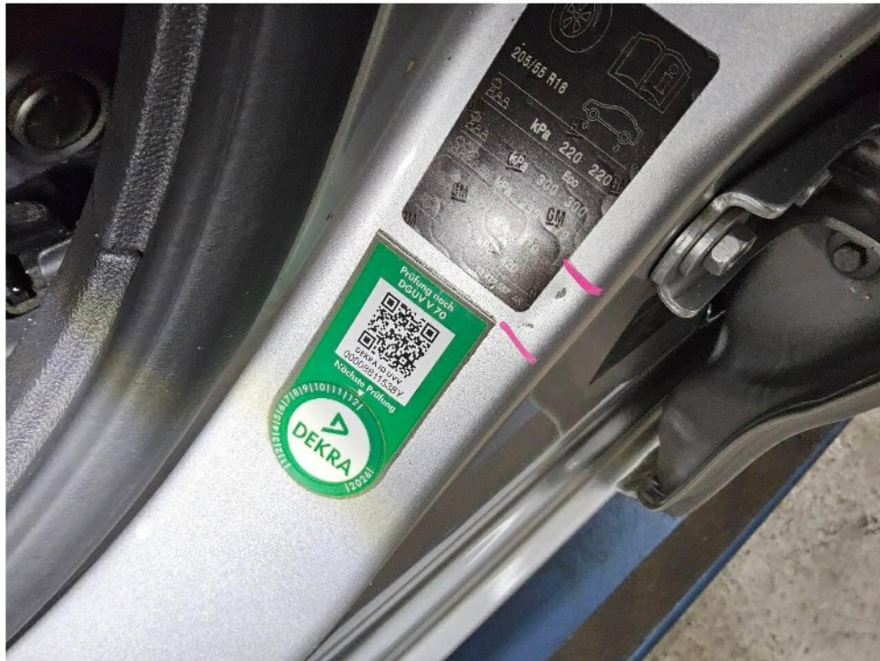
Bild 11 : Tür Einstieg vorne links Kratzer und Delle
