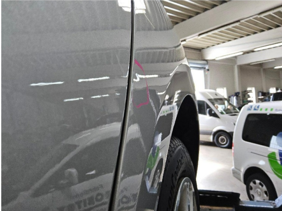
Bild 13 : Seitenwand hinten links Delle
