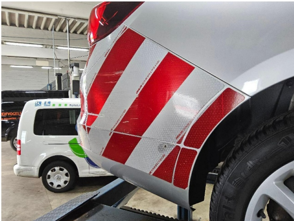
Bild 14 : Stoßfänger vorne und hinten beklebt, entfernen
