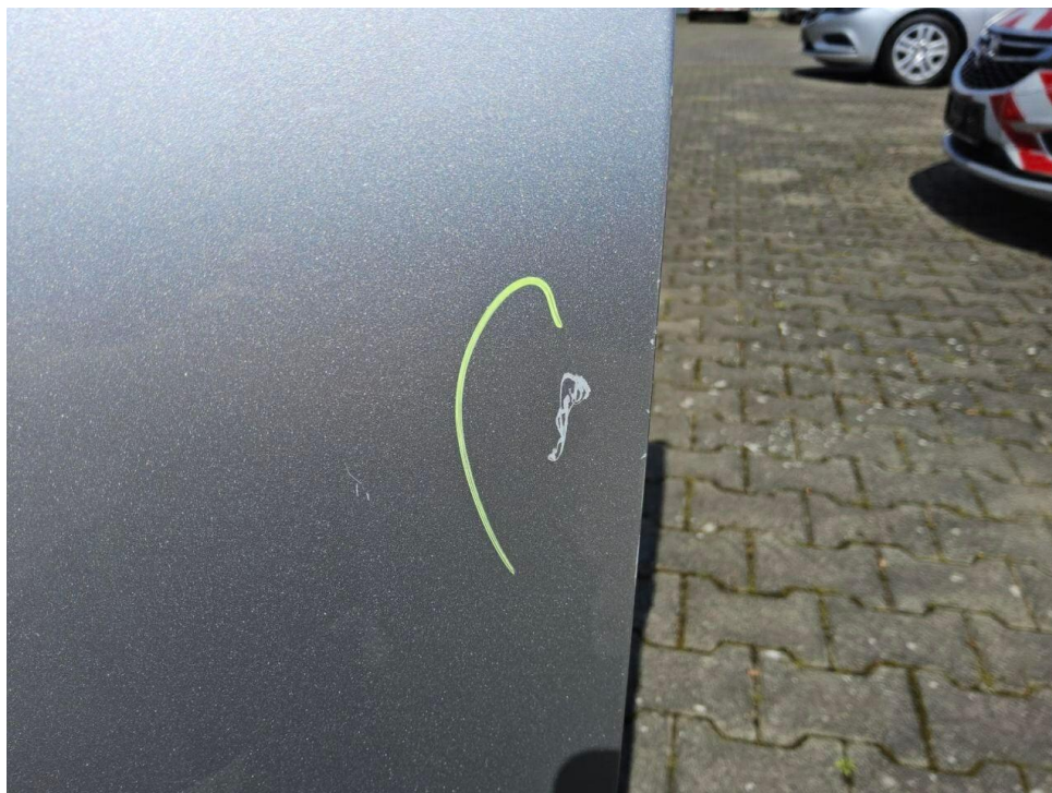
Bild 8 : Tür vorne links Lackierung, zerkratzt, lackieren mit Lackaufbau
