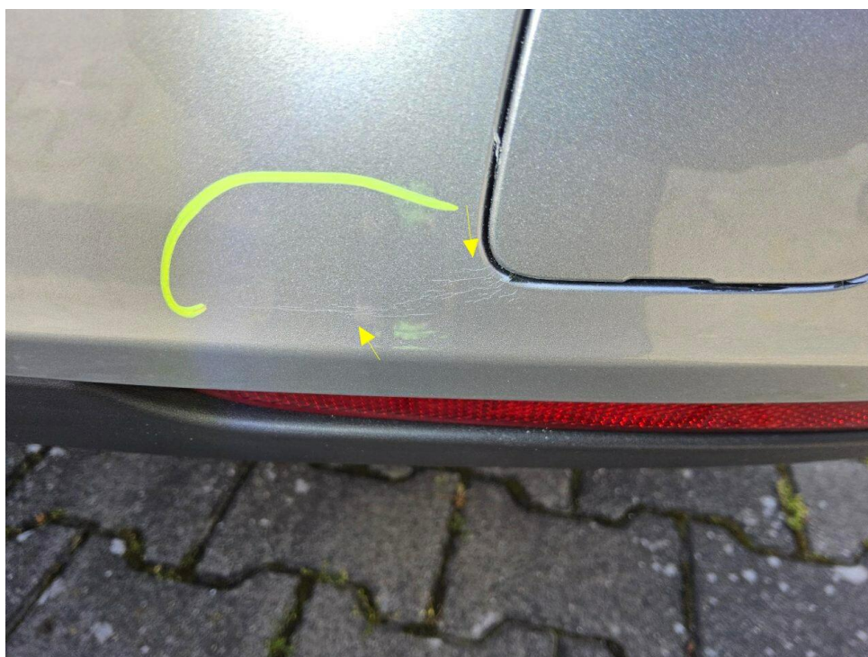
Bild 12 : Stoßfänger hinten Lackierung, gerissen, lackieren mit Lackaufbau
