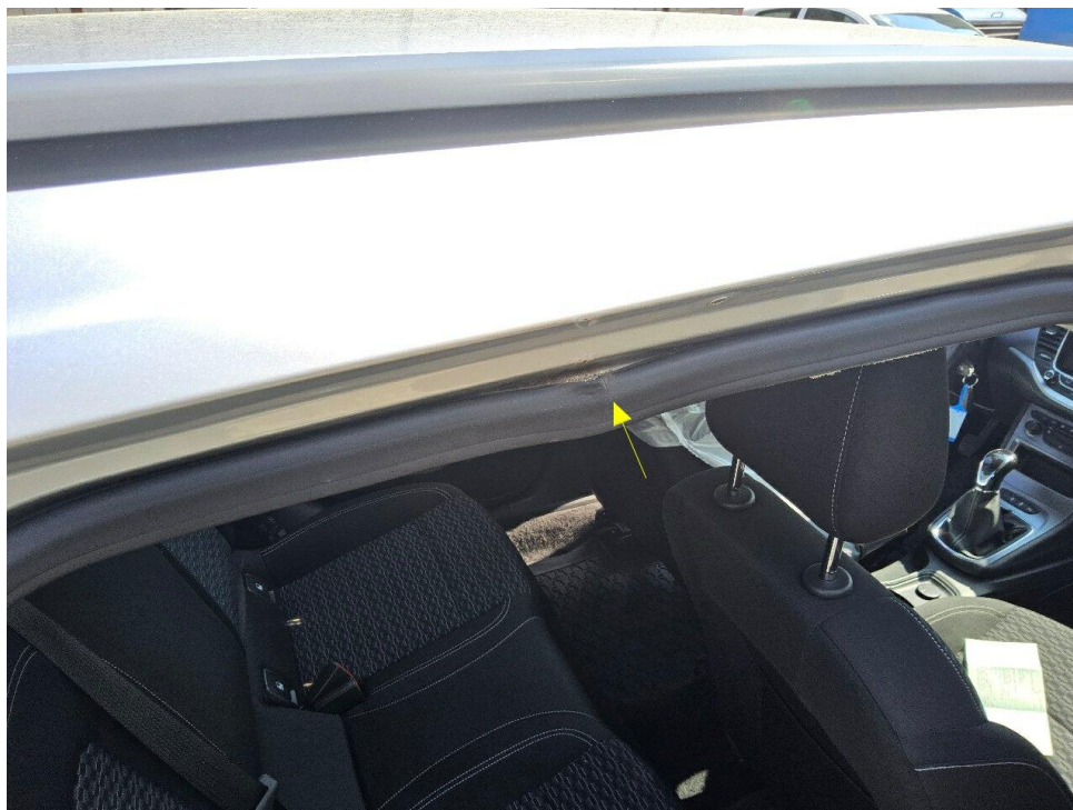
Bild 17 : Dichtung Tür hinten rechts, verformt
