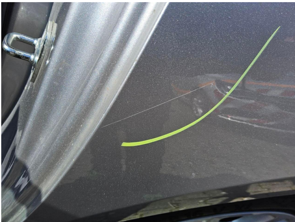
Bild 10 : Seitenteil hinten links Lackierung, zerkratzt, lackieren mit Lackaufbau
