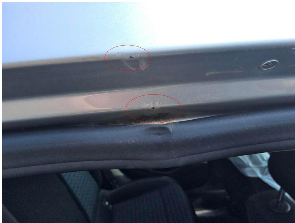
Bild 15 : Dachrahmen rechts Lackierung, zerkratzt, lackieren mit Lackaufbau
