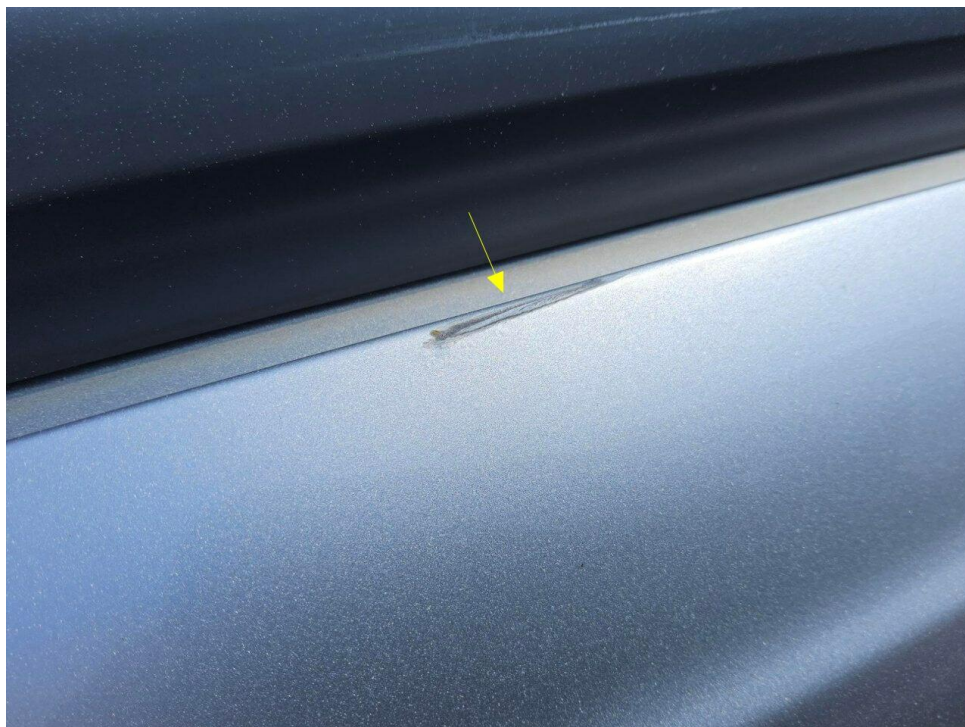
Bild 14 : Dachrahmen rechts Lackierung, zerkratzt, lackieren mit Lackaufbau
