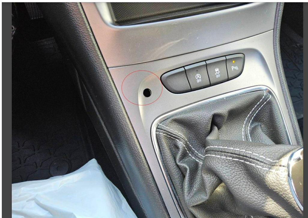
Bild 6 : Blende Schaltknäuf, Loch
