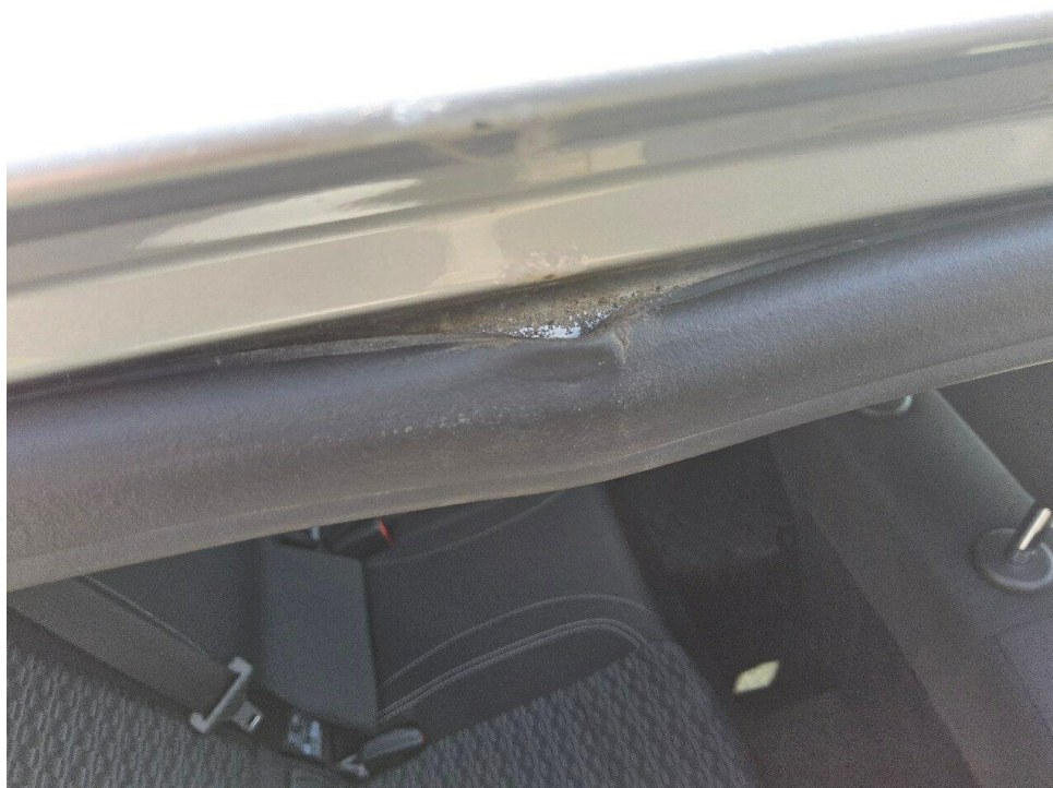
Bild 16 : Dichtung Tür hinten rechts, verformt
