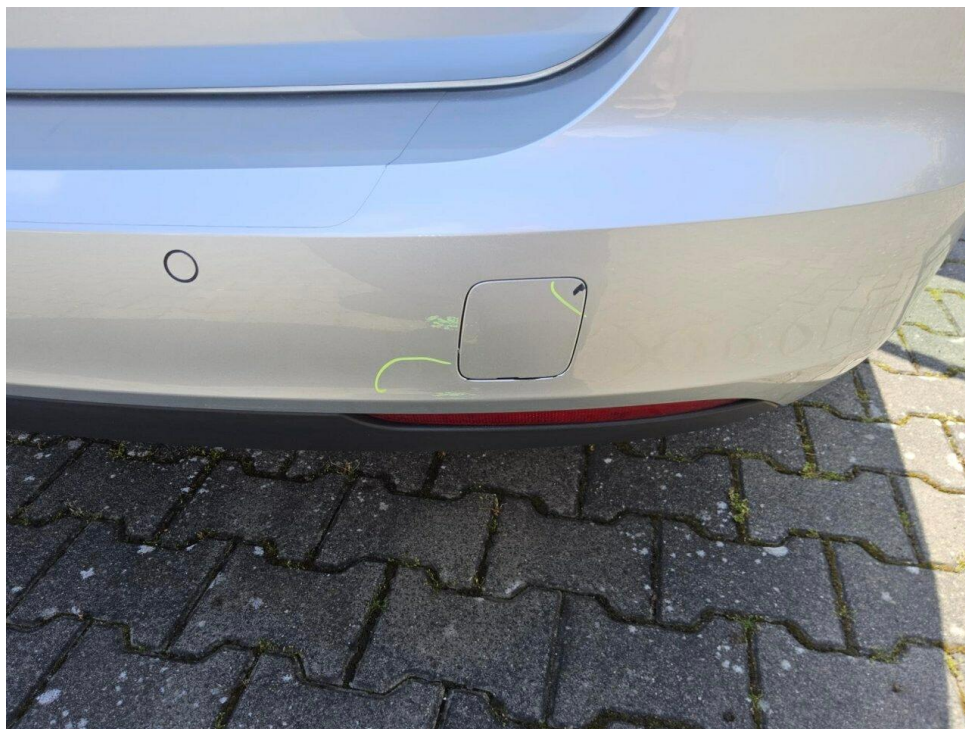
Bild 11 : Stoßfänger hinten Lackierung, gerissen, lackieren mit Lackaufbau
