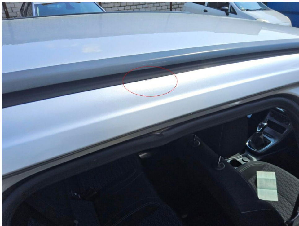
Bild 13 : Dachrahmen rechts Lackierung, zerkratzt, lackieren mit Lackaufbau
