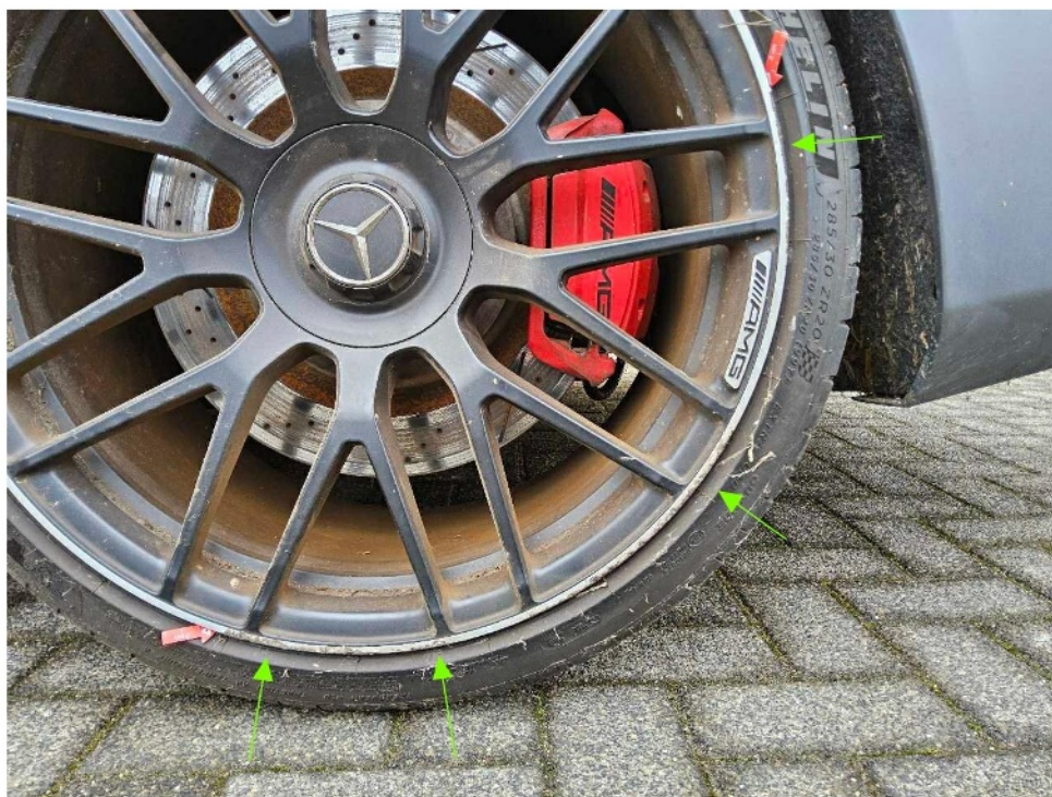
Bild 10 : Glanzgedrehte Felge hinten links, zerkratzt
