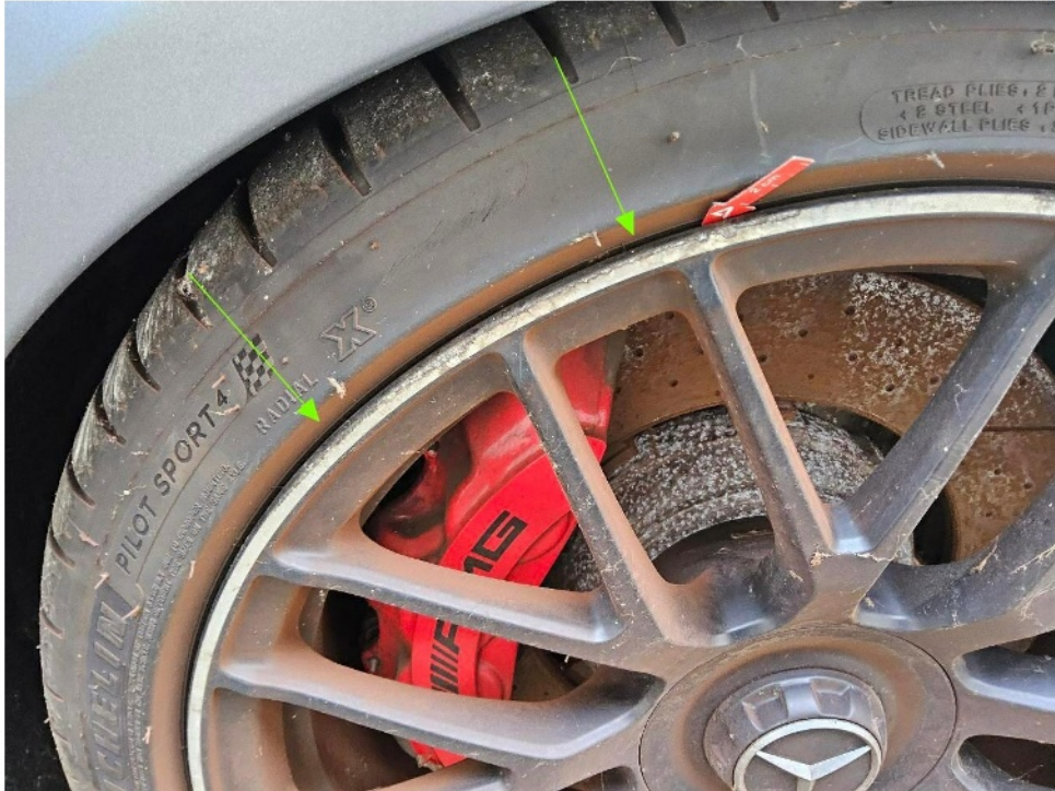
Bild 13 : Glanzgedrehte Felge vorne rechts, zerkratzt
