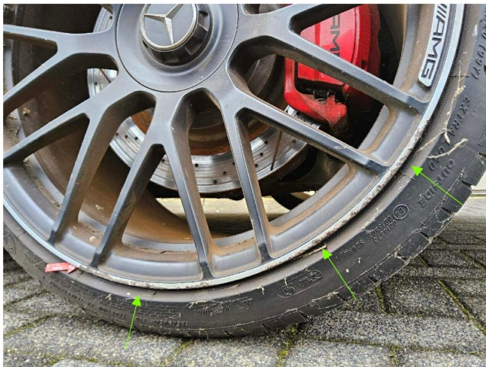
Bild 11 : Glanzgedrehte Felge hinten links, zerkratzt
