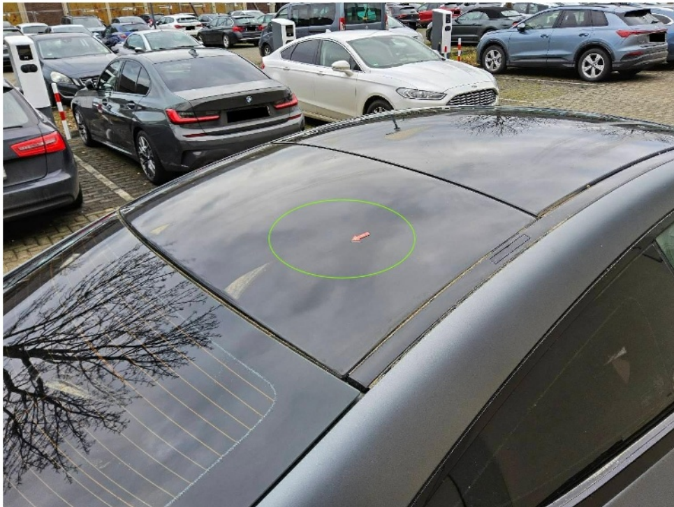
Bild 7 : Dach, Lackierung im hinteren Bereich Strukturfehler und im vorderen Bereich rissig
