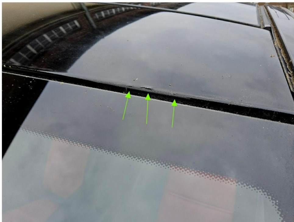
Bild 9 : Dach, Lackierung im hinteren Bereich Strukturfehler und im vorderen Bereich rissig
