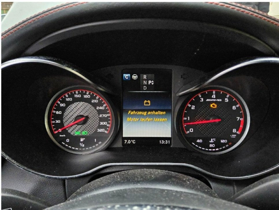
Bild 18 : Starterbatterie tiefenentladen und mehrere Fehlermeldungen, siehe zusätzliche Bemerkungen
