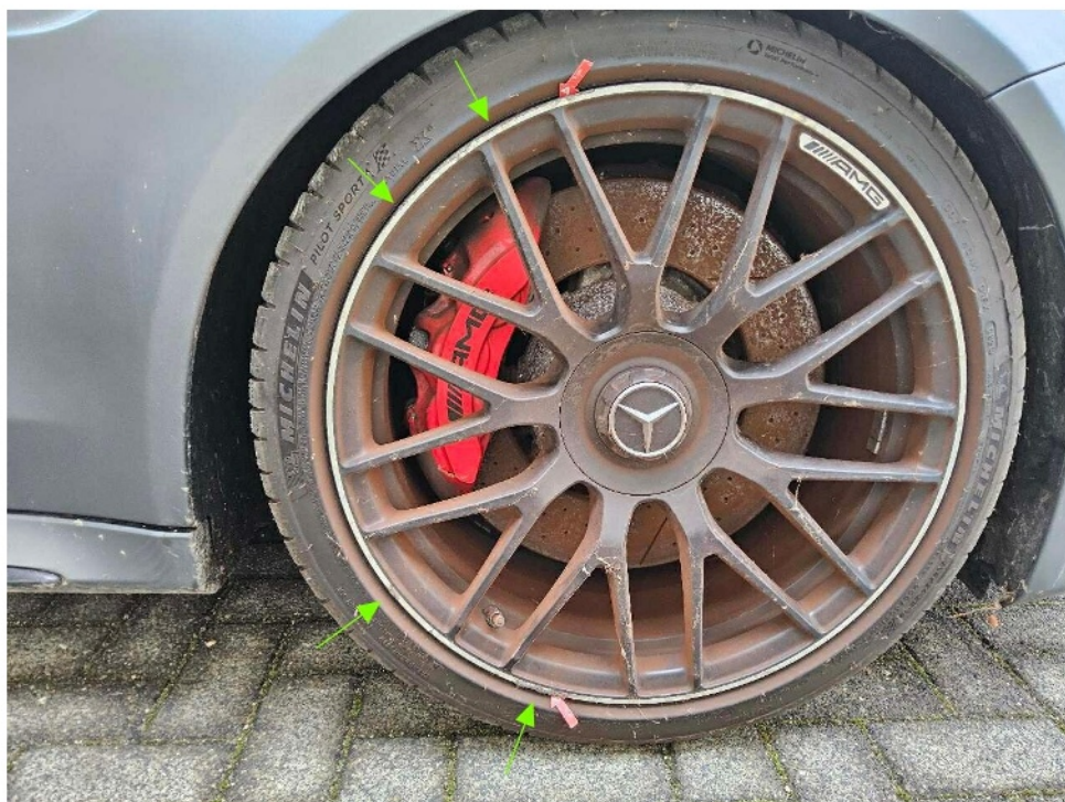
Bild 12 : Glanzgedrehte Felge vorne rechts, zerkratzt
