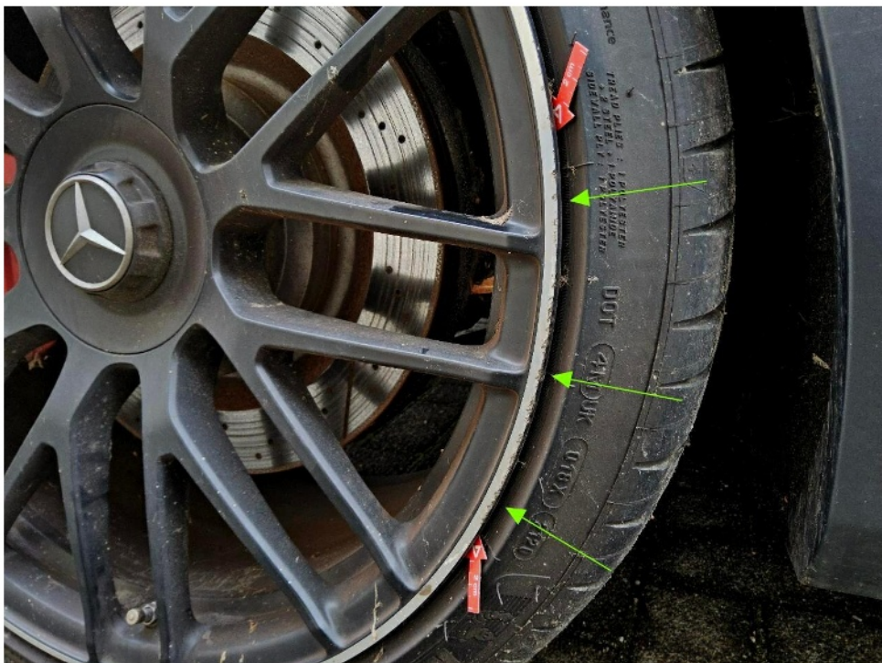
Bild 14 : Glanzgedrehte Felge hinten rechts, zerkratzt
