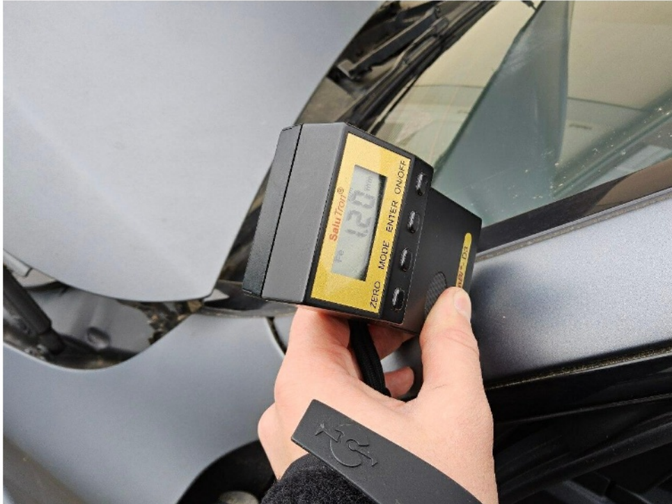
Bild 17 : Lackschichtdicke Dachholm vorne links
