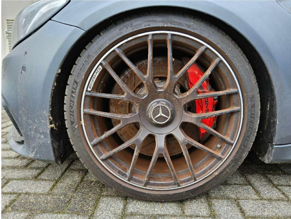
Bild 19 : Bremsscheiben vorne, oxidiert
