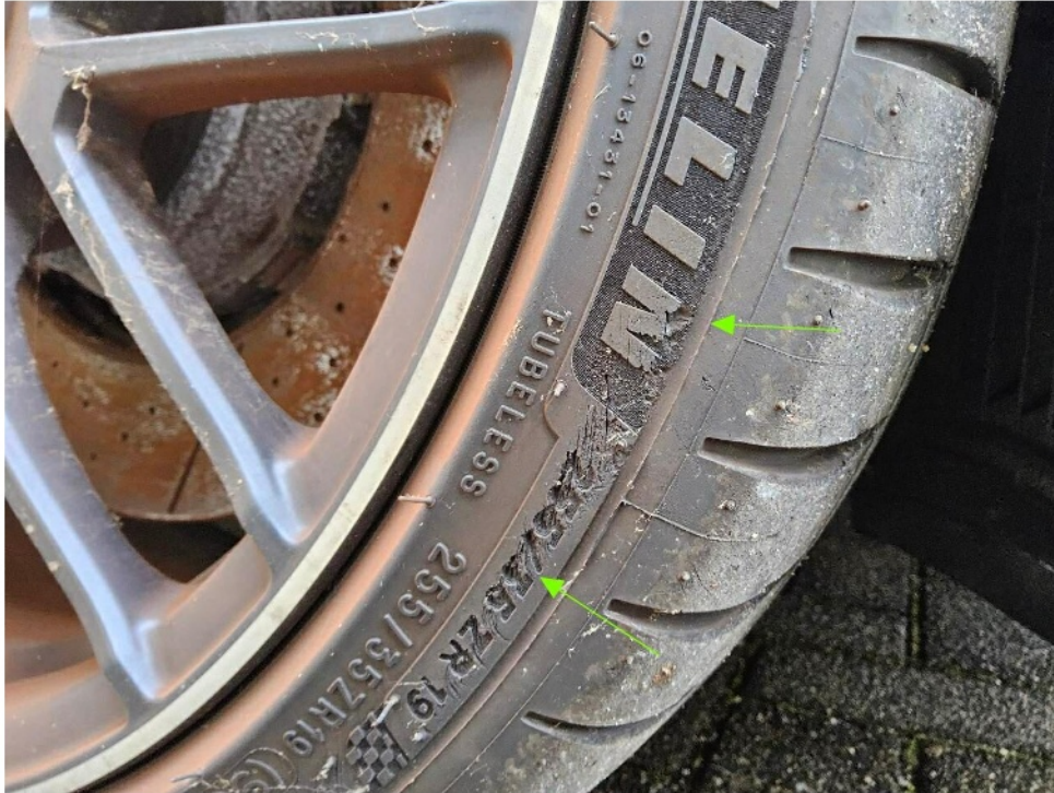
Bild 15 : Reifen vorne rechts, Außenflanke eingeschnitten
