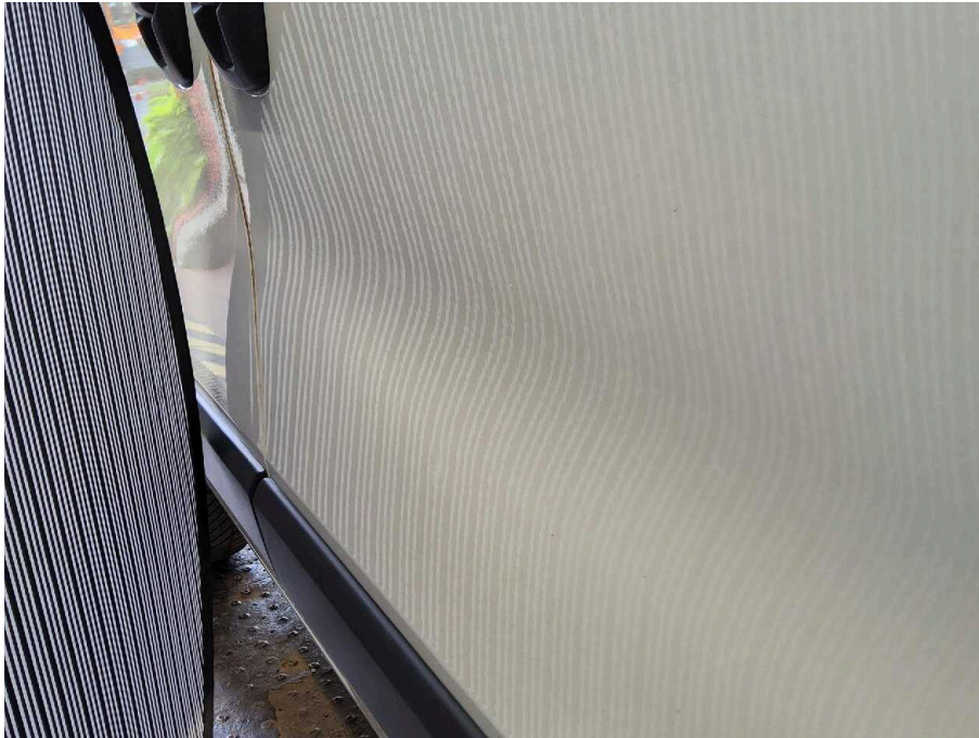
Bild 19 rechte Seite Tür vorne rechts Delle
