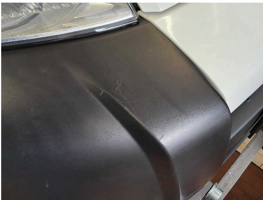
Bild 28 Fahrzeugfront Stoßfänger vorne verkratzt
