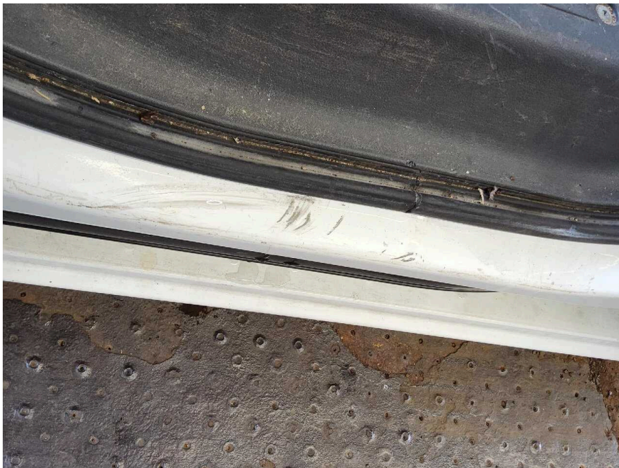
Bild 34 Innenraum Einstieg hinten rechts Delle verkratzt
