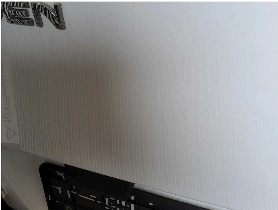
Bild 22 Fahrzeugheck Hecktür links Dellen
