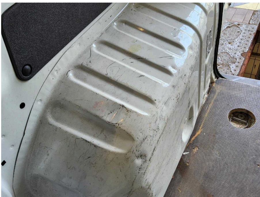
Bild 31 Aufbau Ladefläche Verdellt beschädigt
