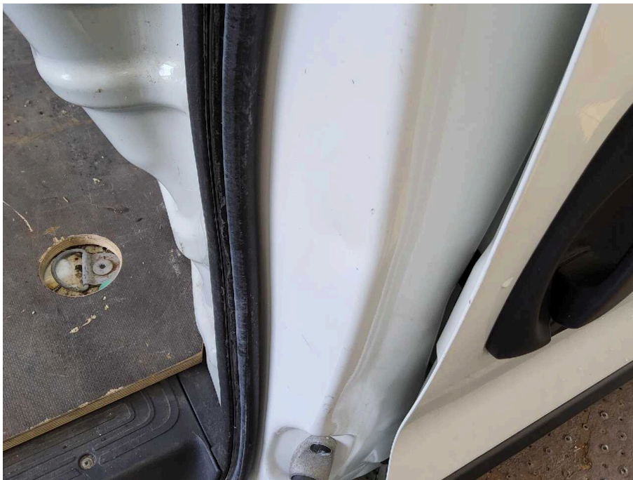
Bild 33 Innenraum Einstieg hinten rechts Delle verkratzt
