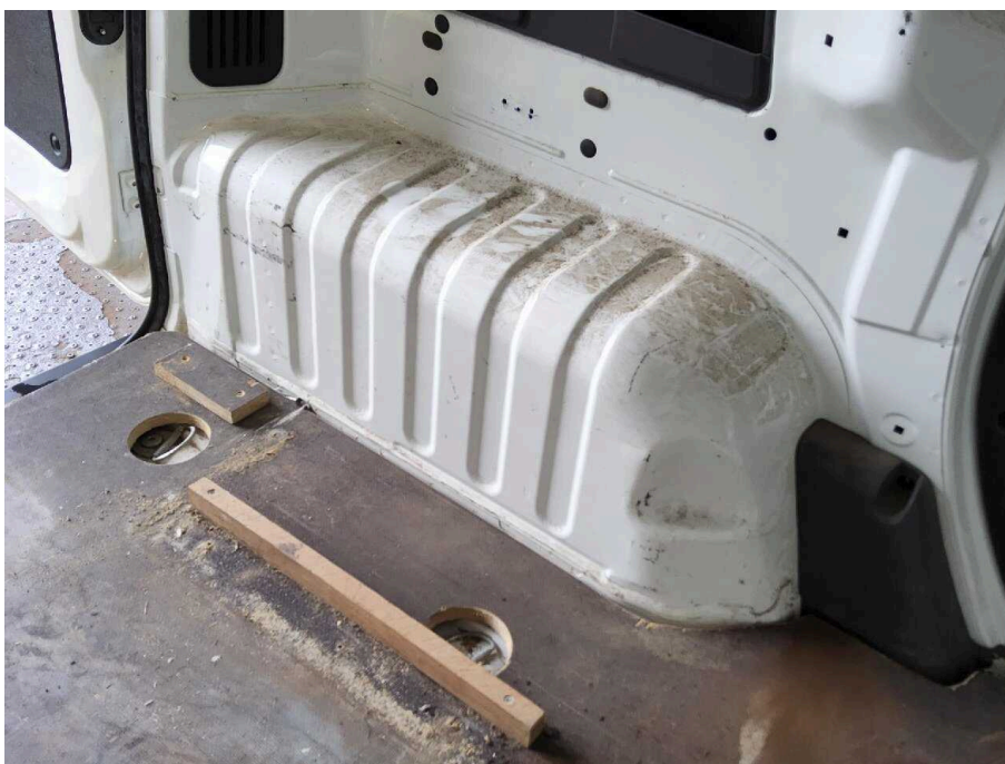
Bild 32 Aufbau Ladefläche Verdellt beschädigt
