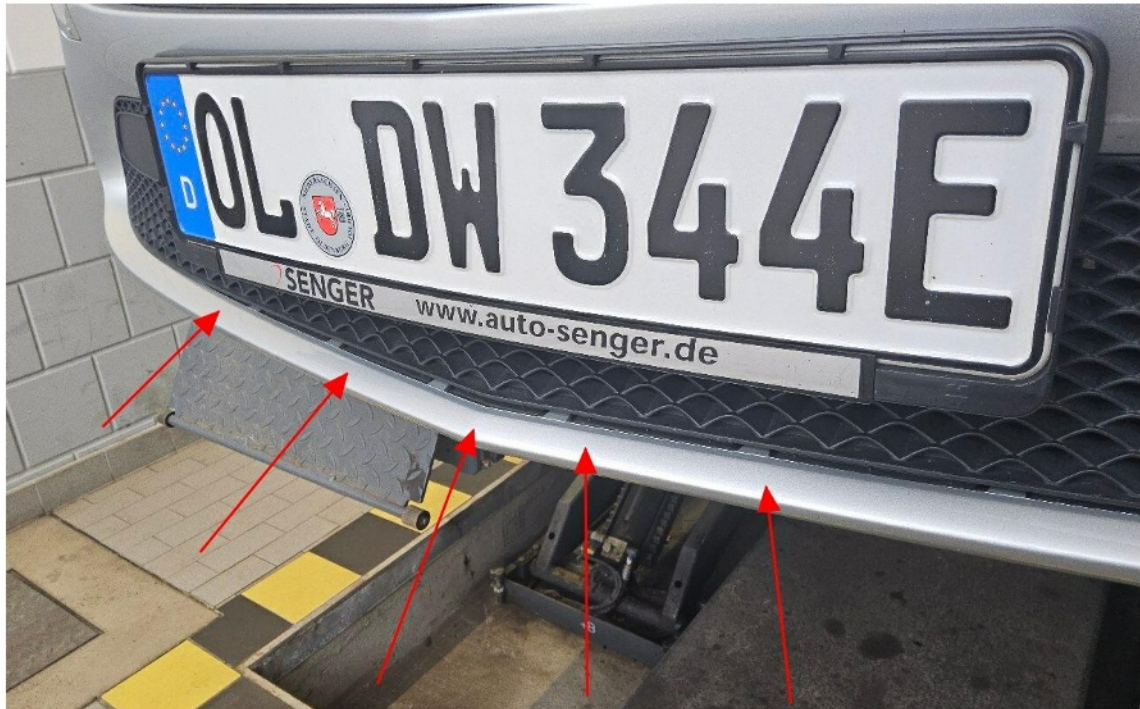
Bild 5 : Stoßfänger vorne, Luftführung, Befestigung nicht stimmig
