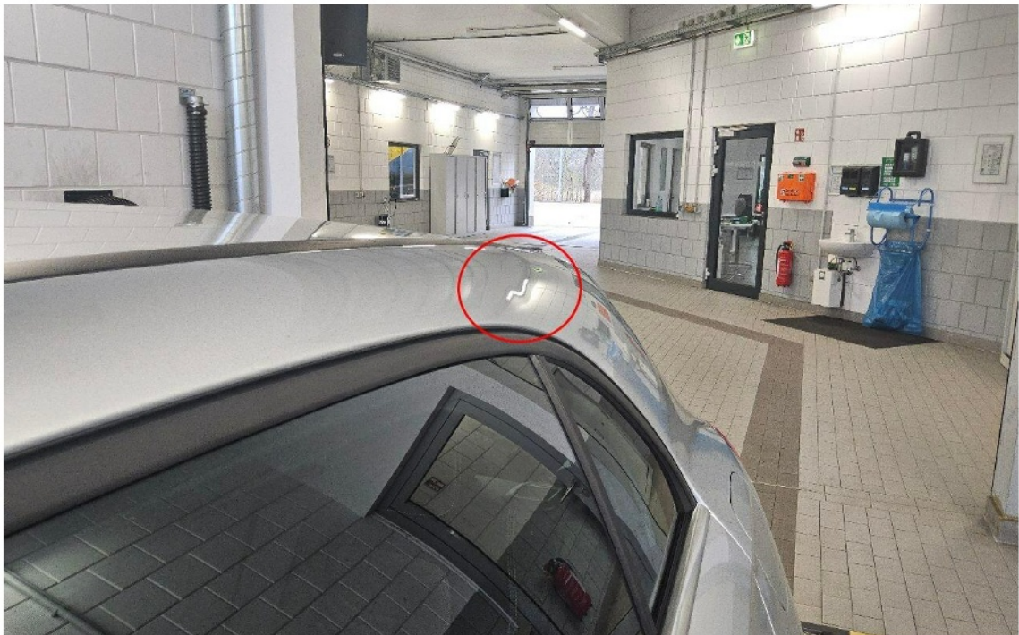
Bild 6 : Dachrahmen links, eingedellt, drücken
