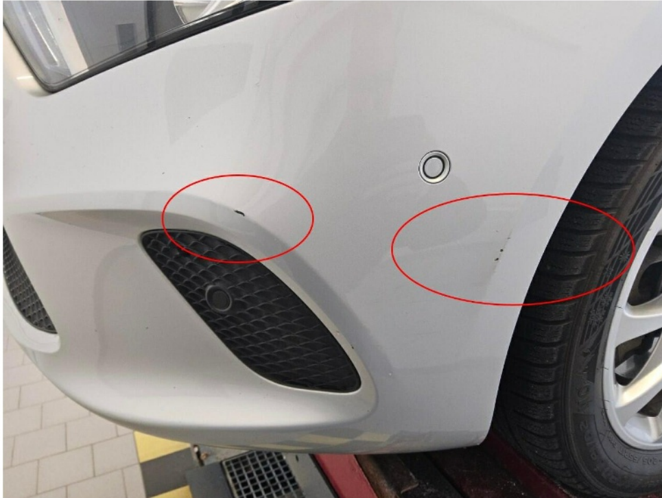
Bild 8 : Stoßfänger vorne Lackierung, verschrammt, lackieren mit Lackaufbau
