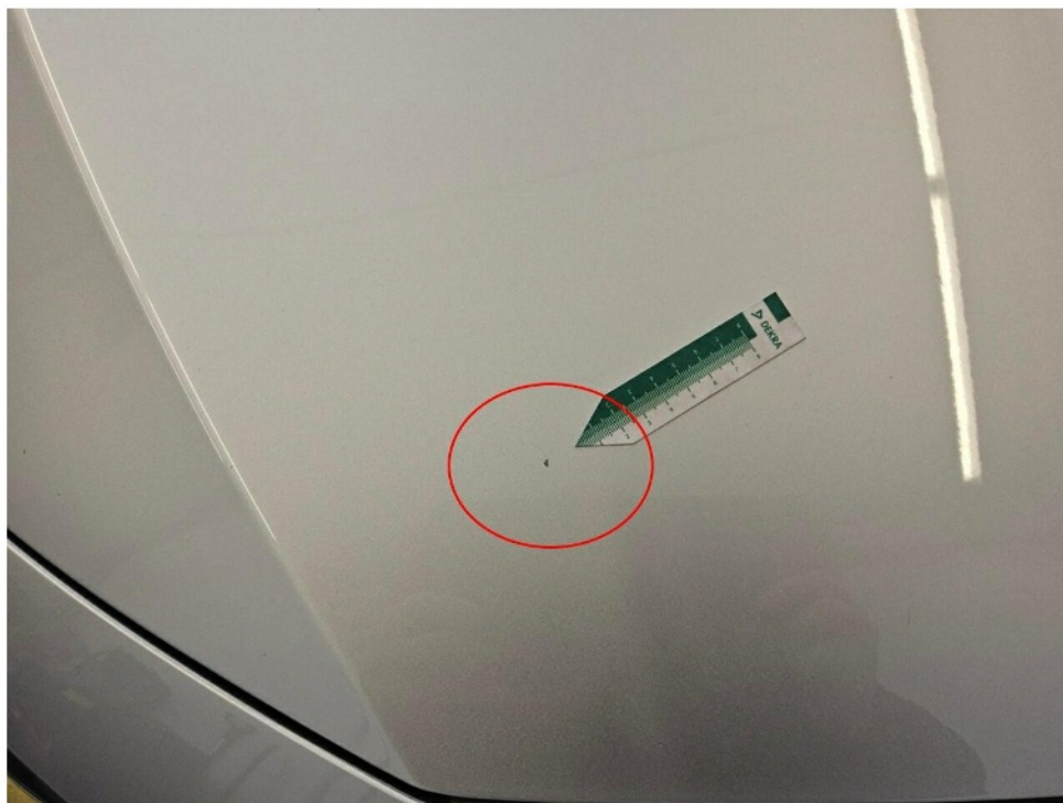
Bild 14 : Motorhaube Lackierung, Steinschlag, lackieren mit Lackaufbau
