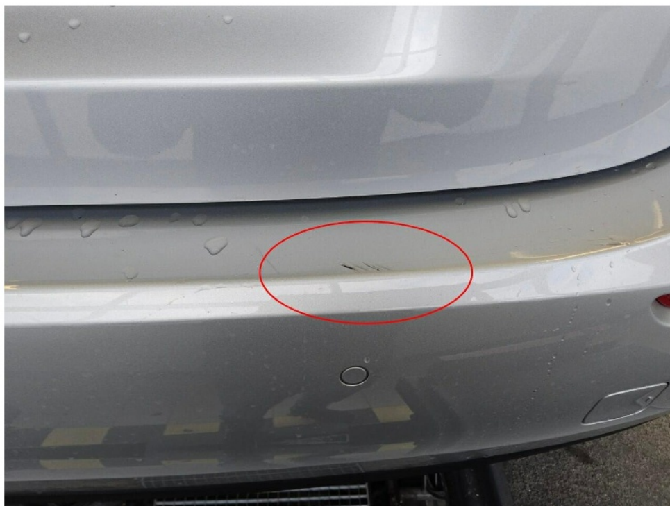
Bild 6 : Stoßfänger hinten Lackierung, zerkratzt, smart repair
