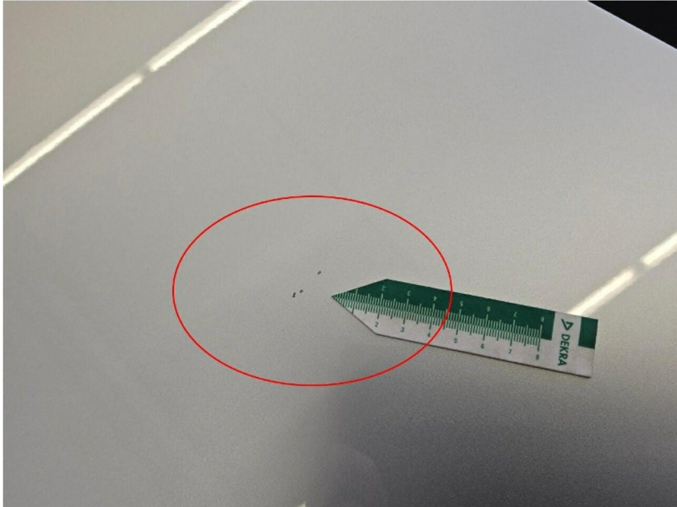
Bild 12 : Motorhaube Lackierung, Steinschlag, lackieren mit Lackaufbau
