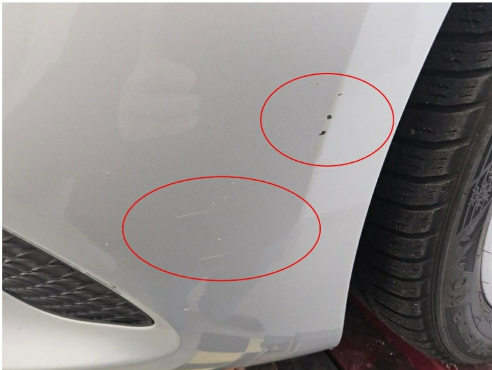
Bild 9 : Stoßfänger vorne Lackierung, verschrammt, lackieren mit Lackaufbau
