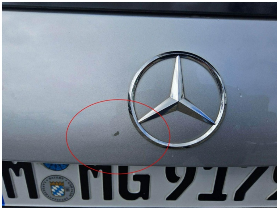
Bild 15 : Heckdeckel Lackierung, zerkratzt, smart repair
