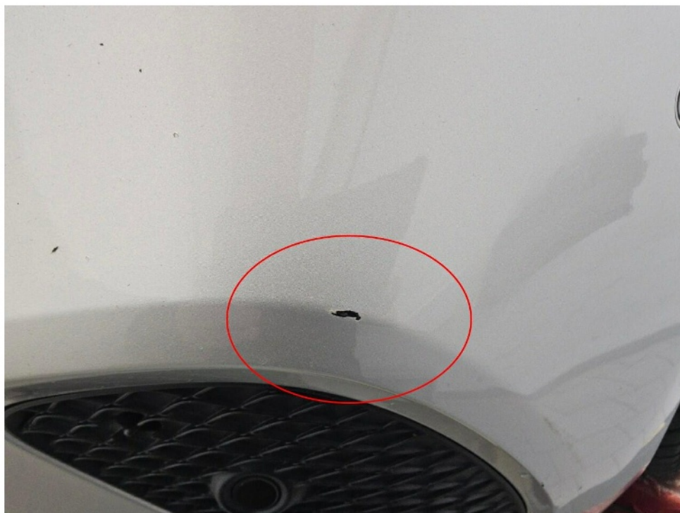
Bild 10 : Stoßfänger vorne Lackierung, verschrammt, lackieren mit Lackaufbau
