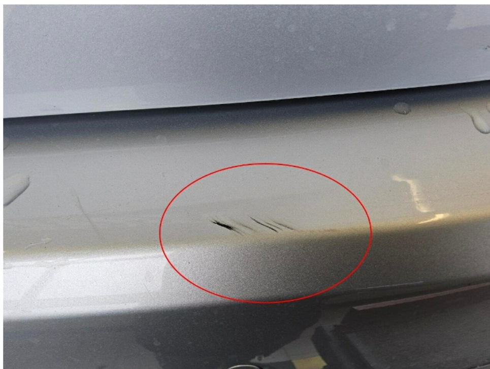
Bild 7 : Stoßfänger hinten Lackierung, zerkratzt, smart repair
