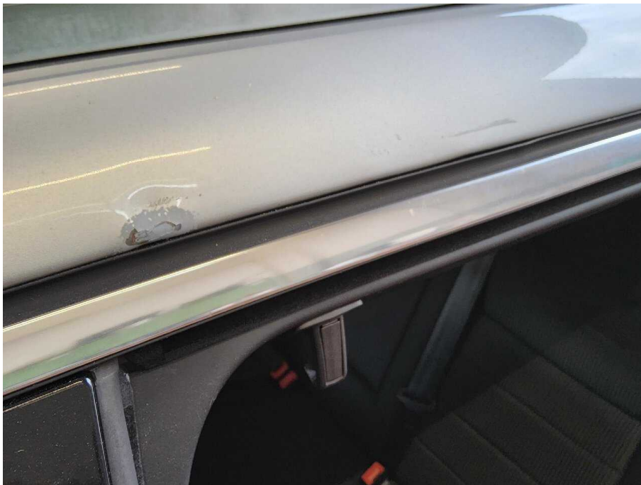
Bild 19 Dach Dachholm links Kratzer Dellen
