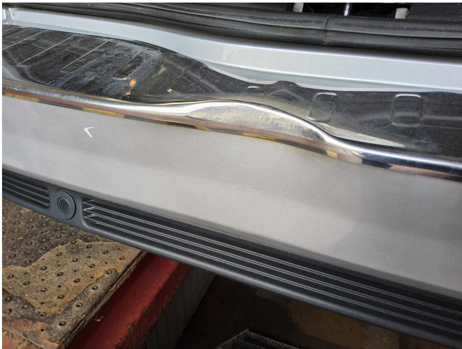
Bild 24 Fahrzeugheck Stoßfänger hinten deformiert
