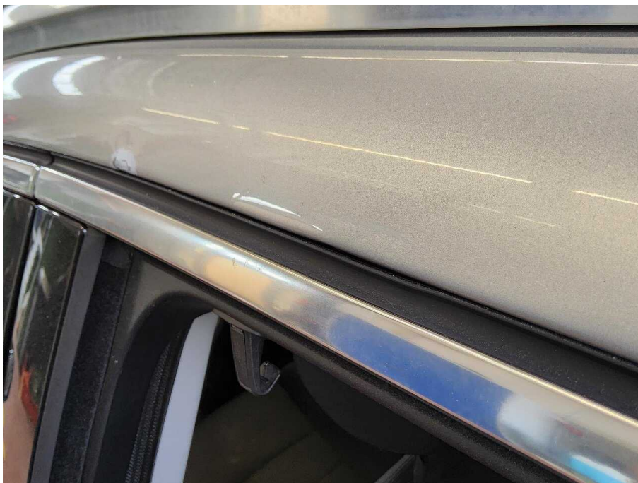
Bild 18 Dach Dachholm links Kratzer Dellen
