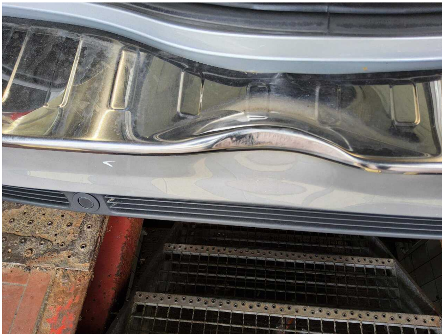
Bild 22 Fahrzeugheck Stoßfänger hinten deformiert
