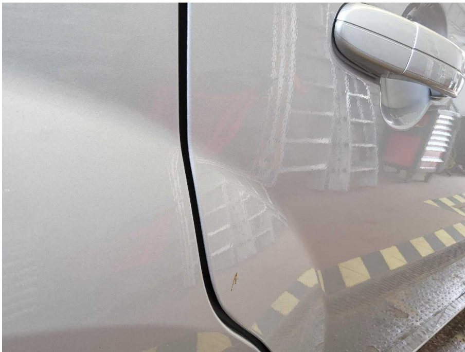
Bild 25 Fahrzeugheck Tür hinten rechts Delle
