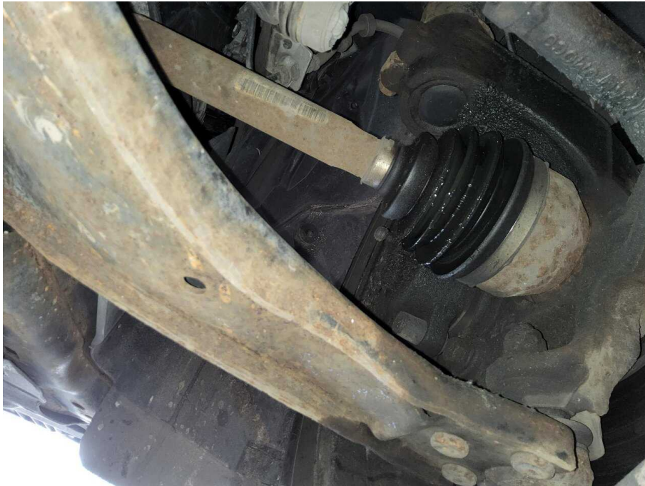
Bild 27 Getriebe / Antrieb Antriebswellen Manschette rechts aussen 1. Achse gerissen / eingerissen
