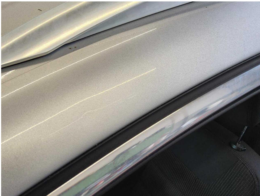
Bild 20 Dach Dachholm links Kratzer Dellen
