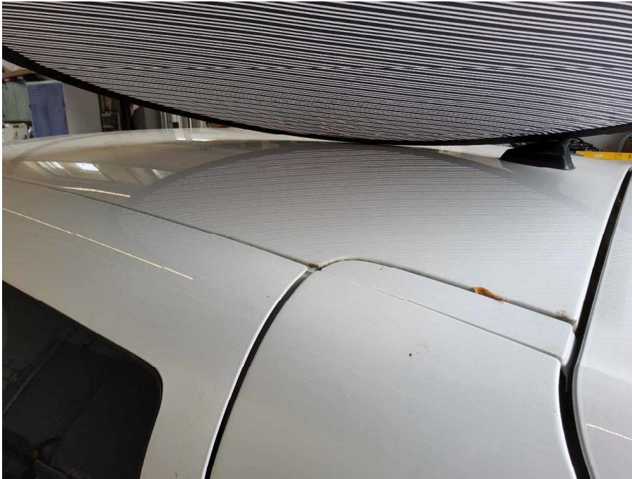
Bild 27 Dach Dachhaut Dellen
