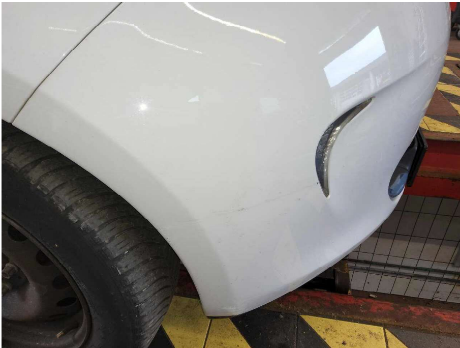
Bild 16 Fahrzeugfront Stoßfänger vorne Kratzer
