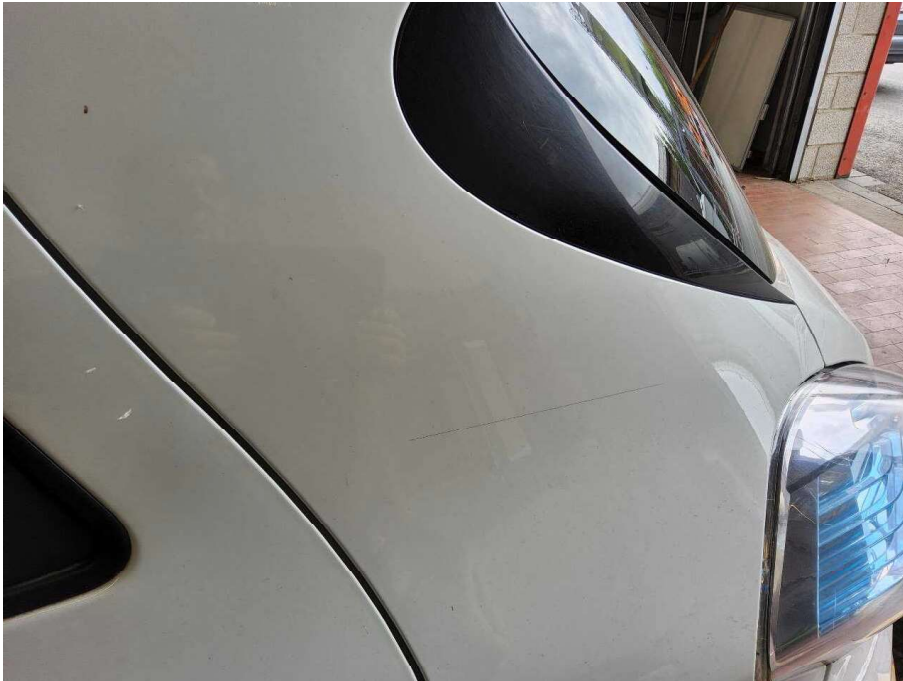
Bild 23 linke Seite Seitenteil hinten links Kratzer
