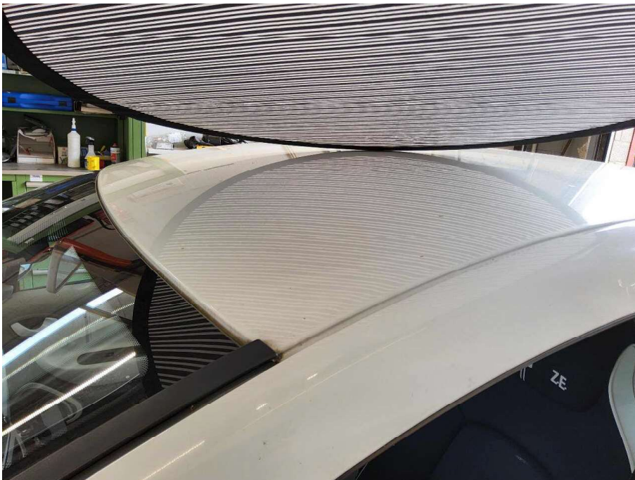
Bild 28 Dach Dachhaut Dellen
