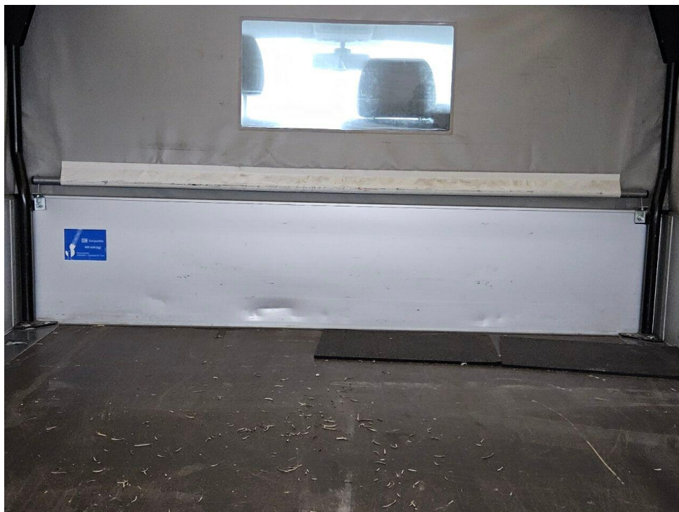
Bild 5 : Rückwand Ladefläche, verformt
