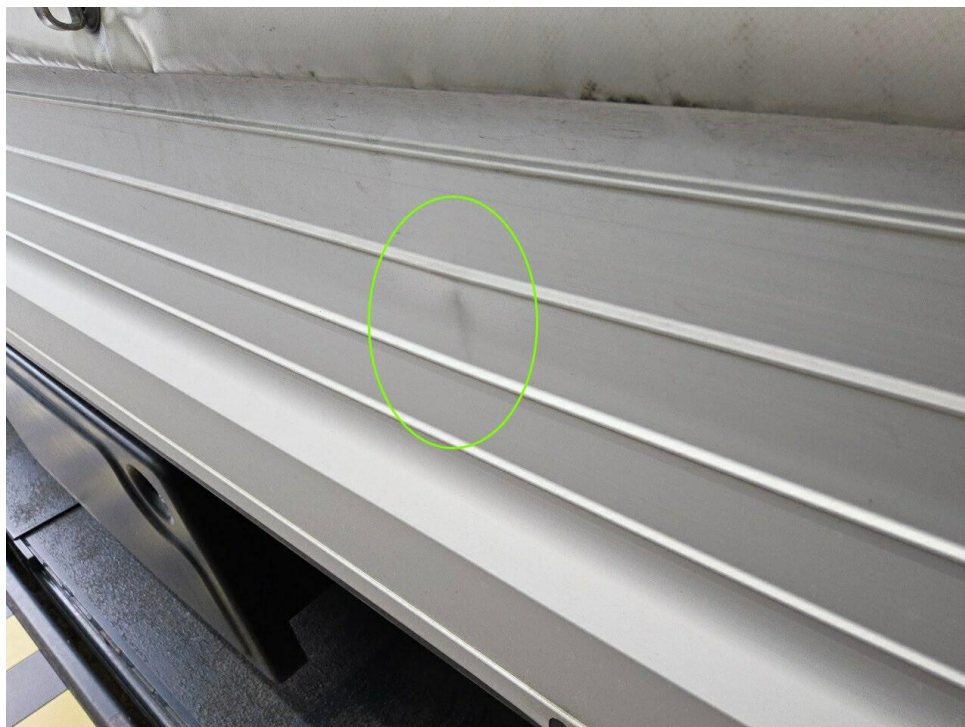
Bild 6 : Ladebordwand links, verformt und verschrammt
