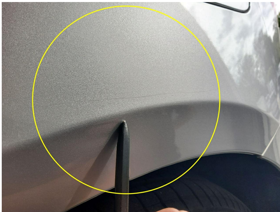
Bild 11 : Seitenwand links lackierung verschrammt
