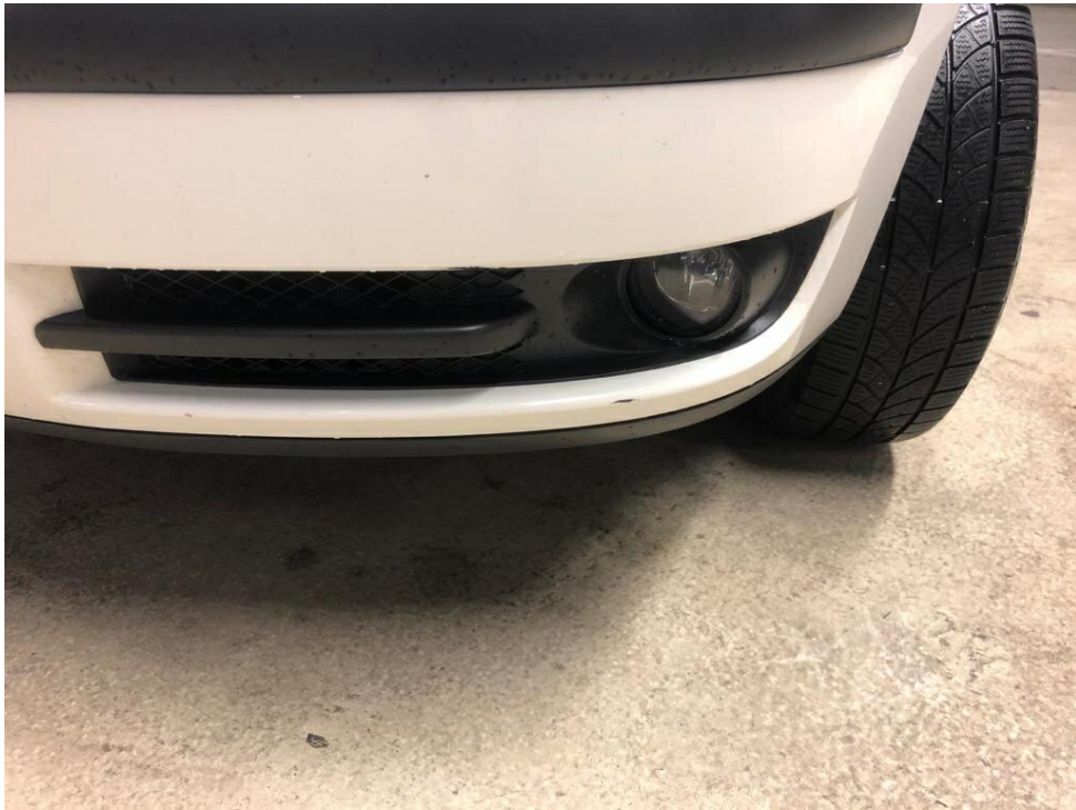
Bild 10 : Stoßfänger vorne verschrammt
