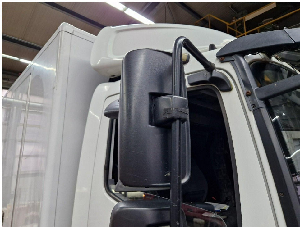
Bild 12 : ASP rechts Abdeckung gebrochen
