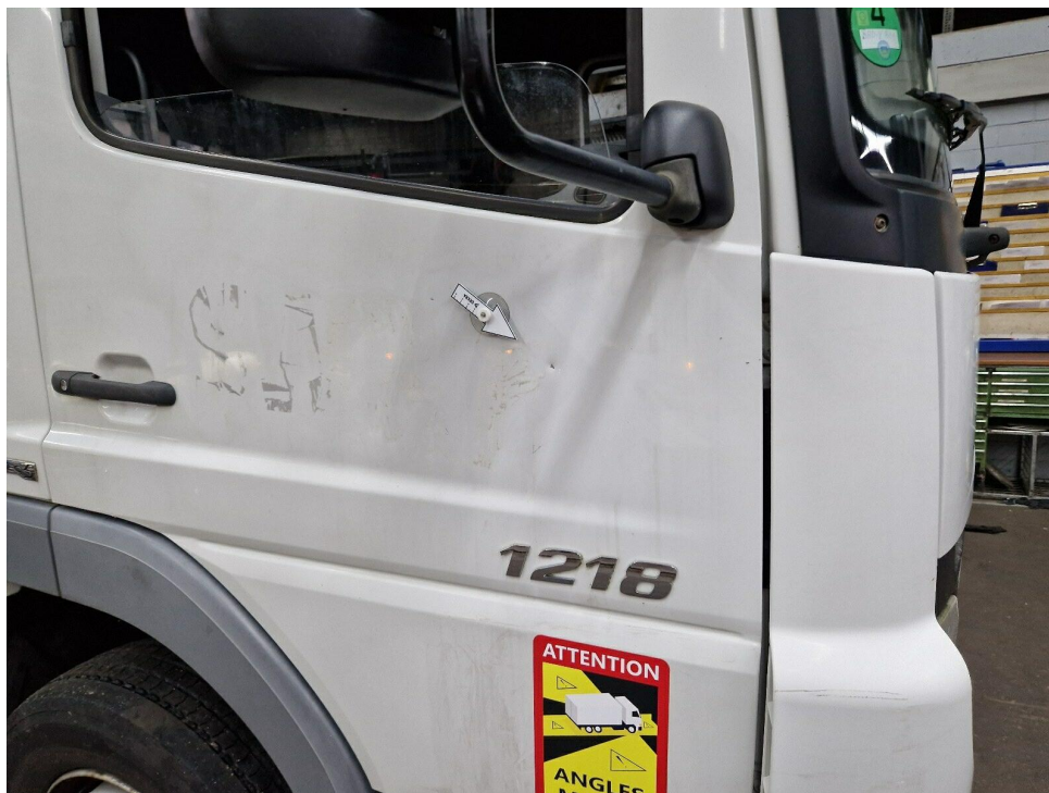
Bild 15 : Tür rechts Delle
