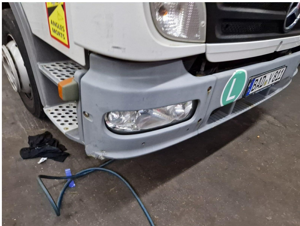
Bild 9 : Stoßfänger rechts gebrochen
