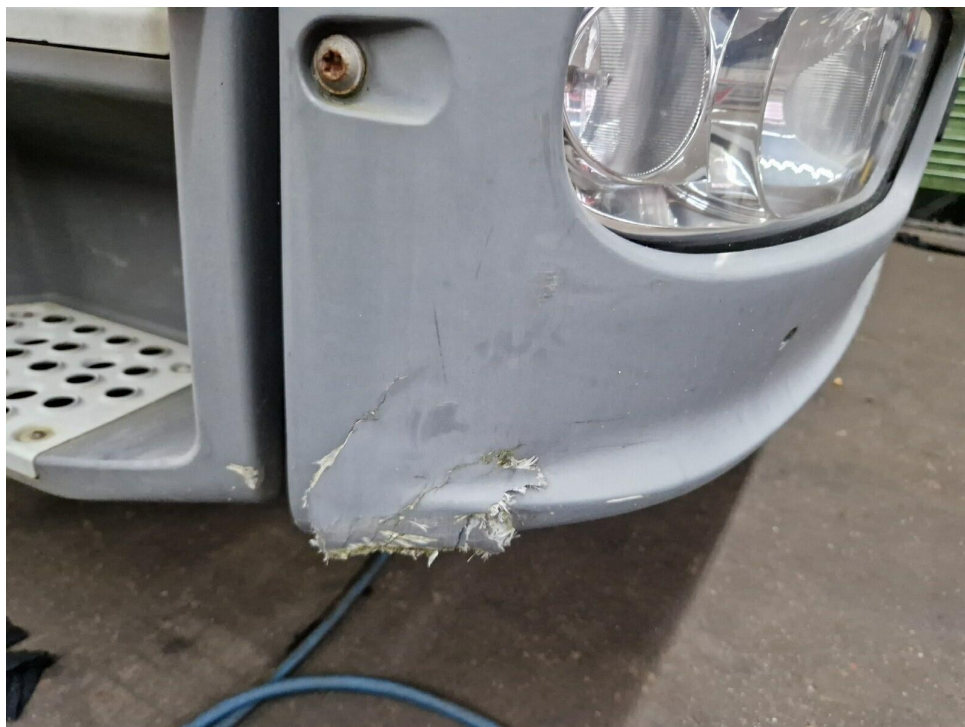
Bild 10 : Stoßfänger rechts gebrochen
