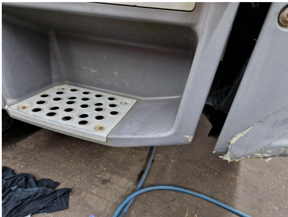
Bild 11 : Einstieg rechts unten verschrammt
