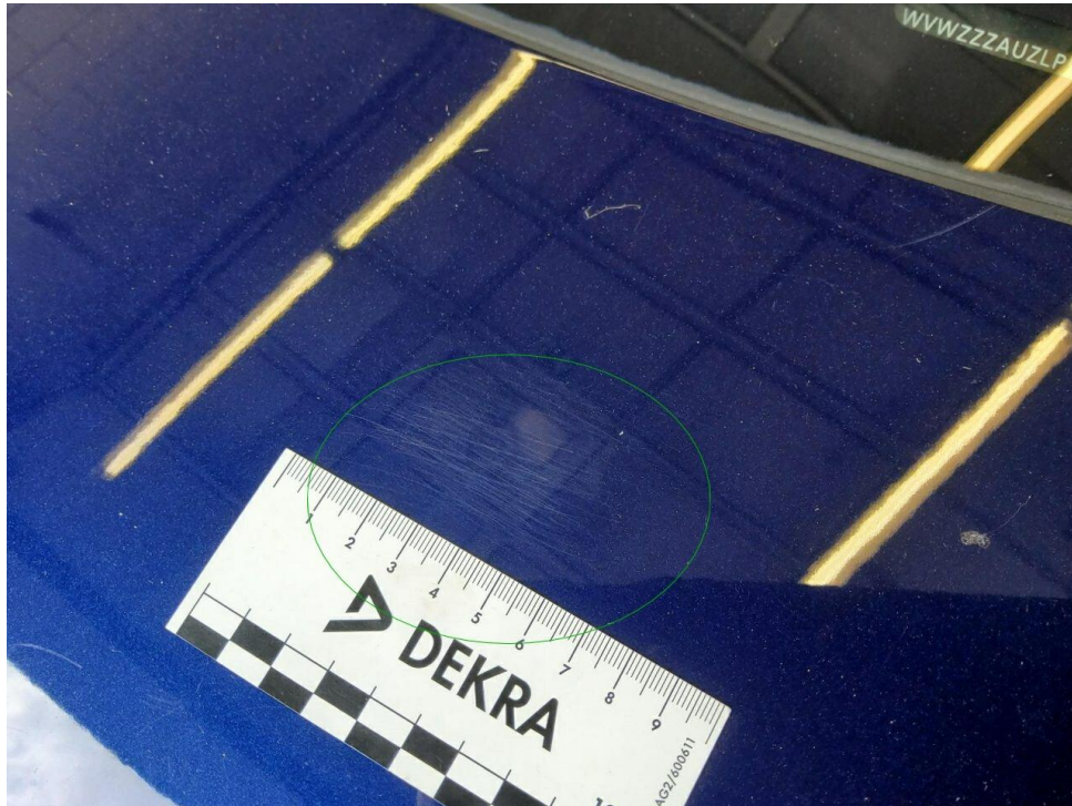
Bild 15 : Motorhaube Lackierung, zerkratzt, polieren
