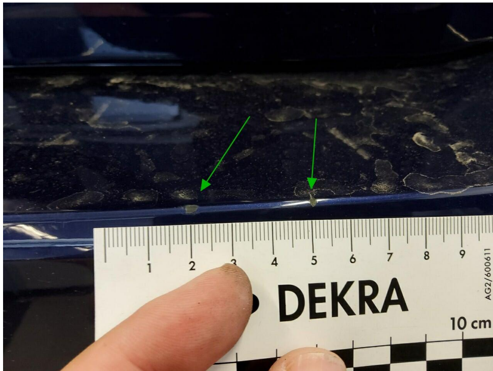
Bild 13 : Stoßfänger hinten Lackierung, zerkratzt, lackieren mit Lackaufbau
