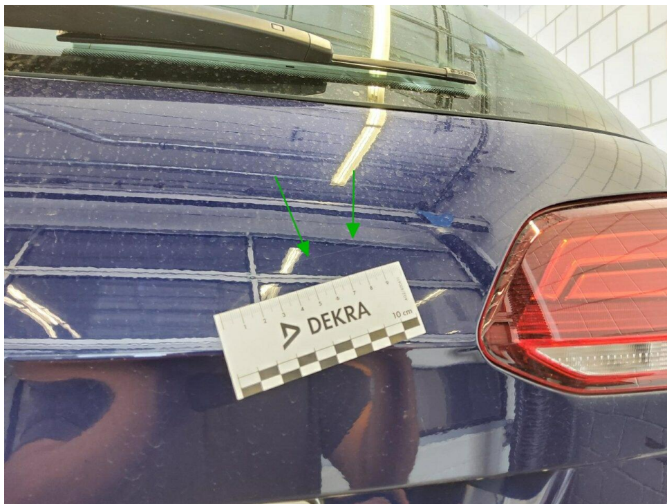
Bild 9 : Heckklappe Lackierung oberhalb, zerkratzt, lackieren
