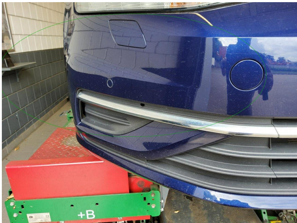
Bild 6 : Stoßfänger vorne, viele Steinschläge, Gebrauchsspur
