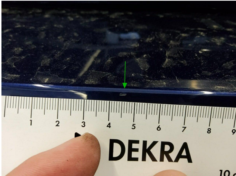
Bild 11 : Stoßfänger hinten Lackierung, zerkratzt, lackieren mit Lackaufbau
