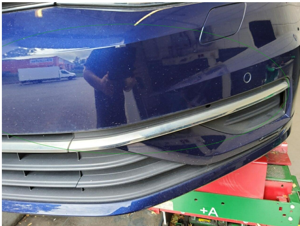
Bild 7 : Stoßfänger vorne, viele Steinschläge, Gebrauchsspur
