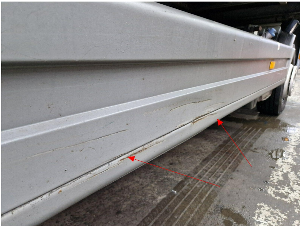
Bild 20 : Seitenverkleidung rechts mehrfach eingedrückt/ verschrammt
