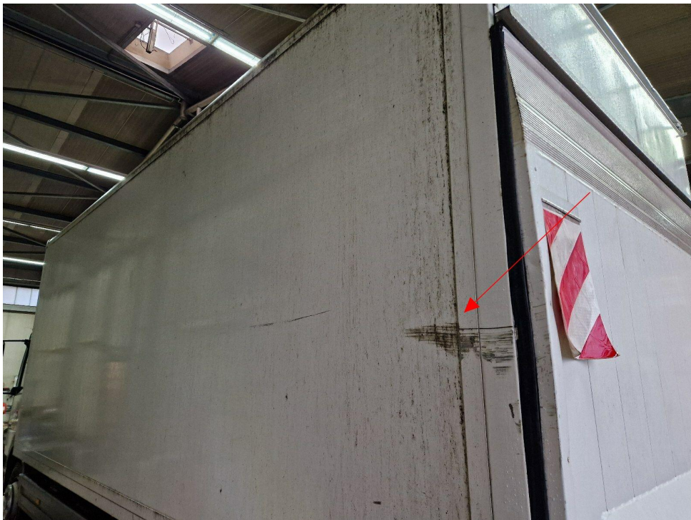
Bild 14 : Kofferaufbau Eckprofil hinten links/ Seitenwand link verschrammt
