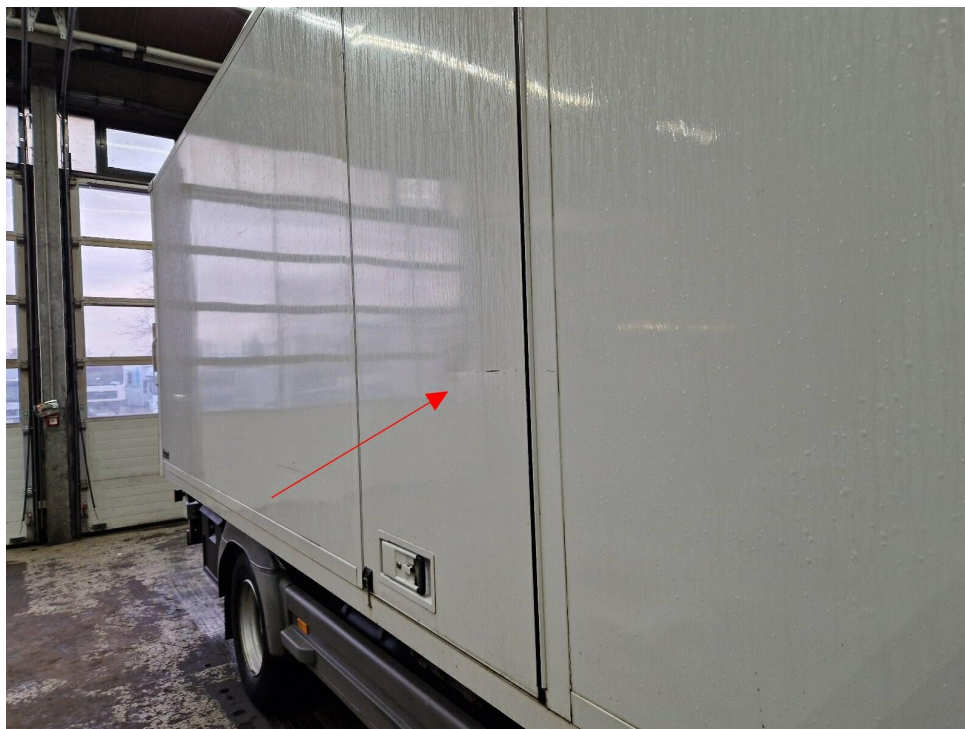
Bild 23 : Kofferaufbau Tür rechts eingedrückt
