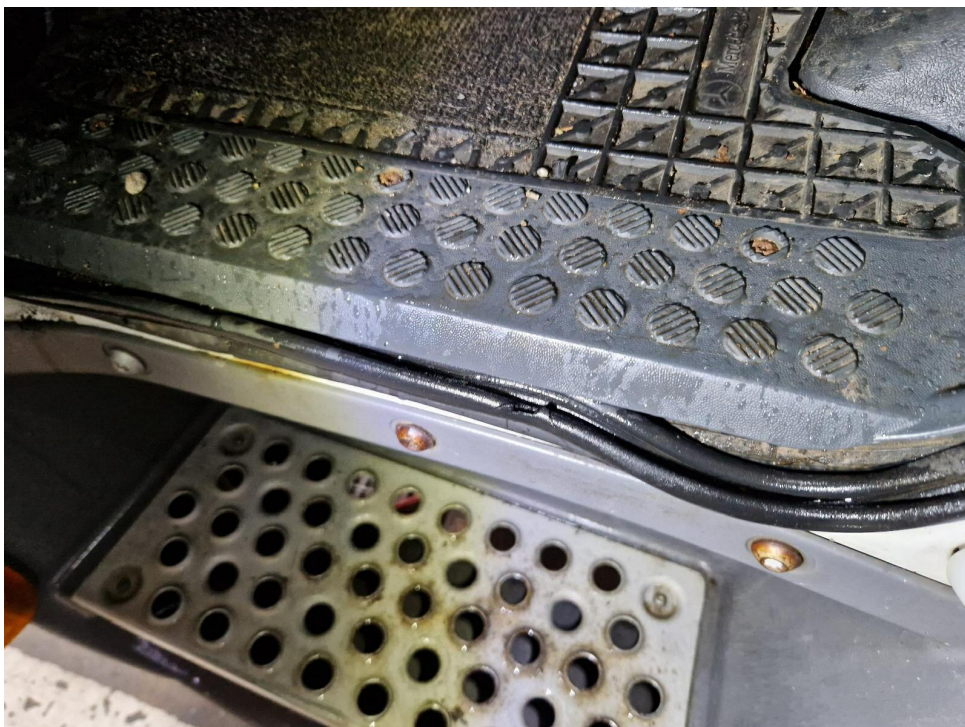
Bild 32 : Einstieg links Türgummi leicht eingerissen
