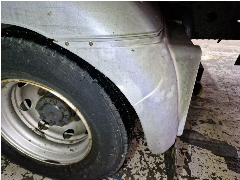
Bild 13 : Kotflügel HA links hinten verformt
