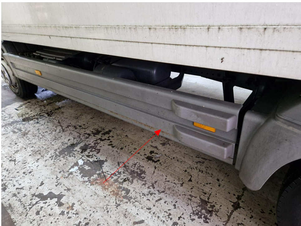
Bild 10 : Seitenverkleidung links gebrochen
