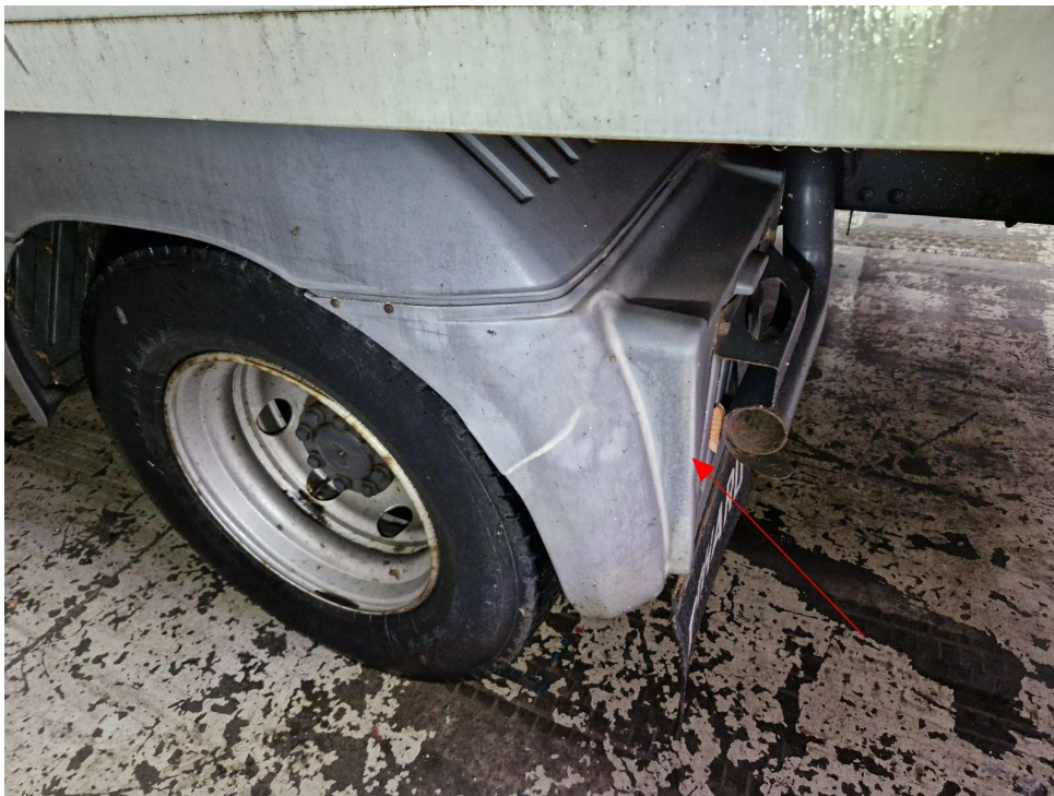
Bild 12 : Kotflügel HA links hinten verformt
