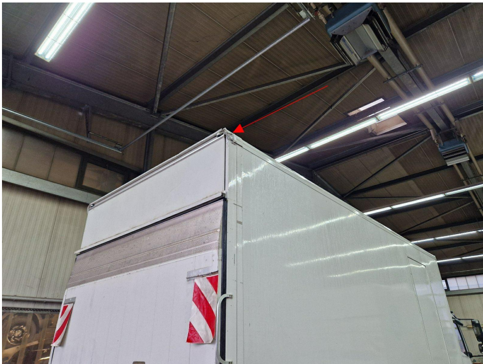
Bild 16 : Kofferaufbau Eckprofil hinten rechts/ Seitenwand eingedrückt
