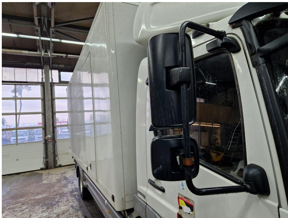
Bild 30 : ASP rechts verschrammt
