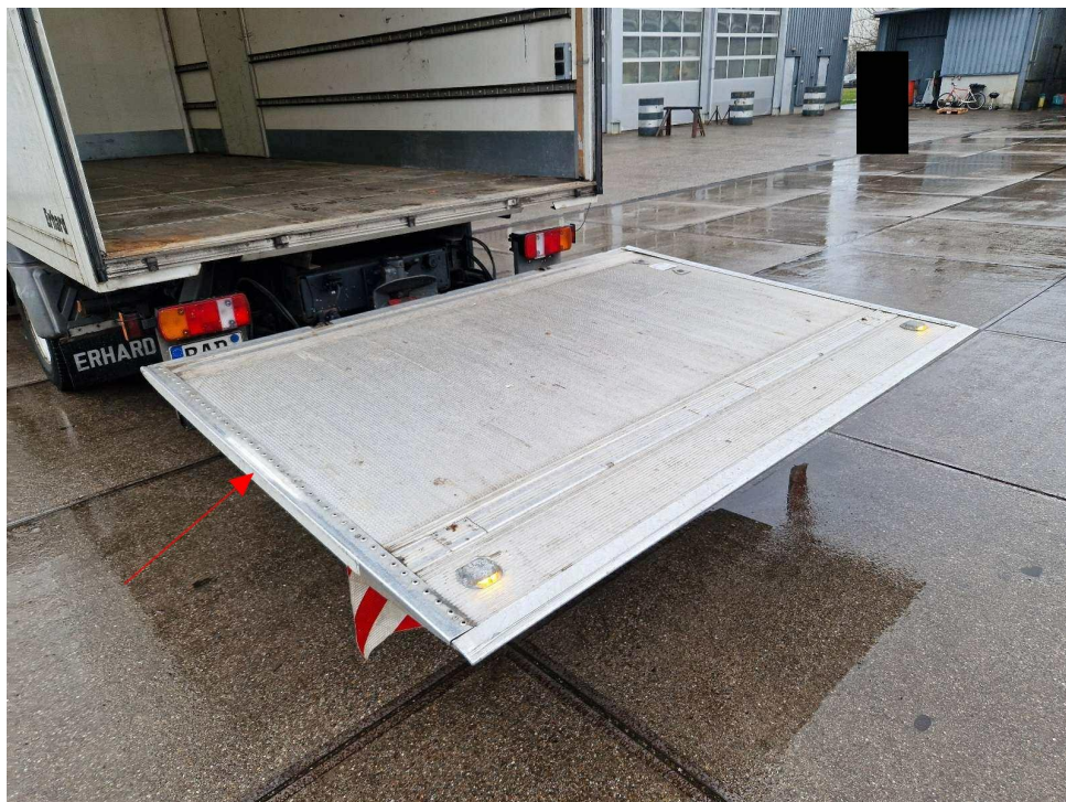
Bild 8 : Ladebordwand Seitenprofil links eingedrückt
