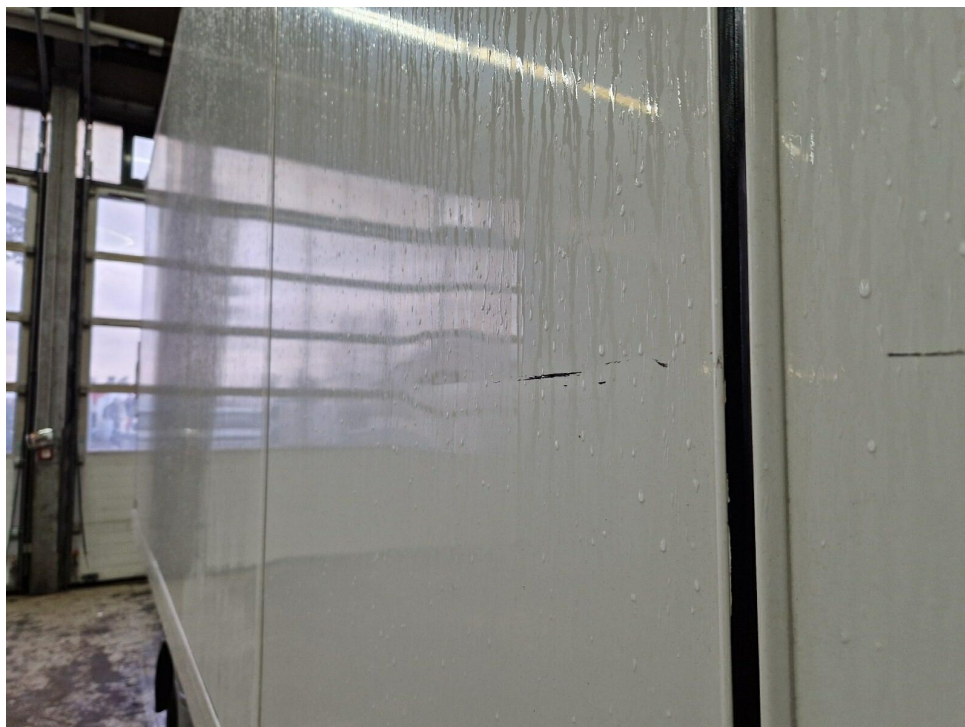
Bild 24 : Kofferaufbau Tür rechts eingedrückt
