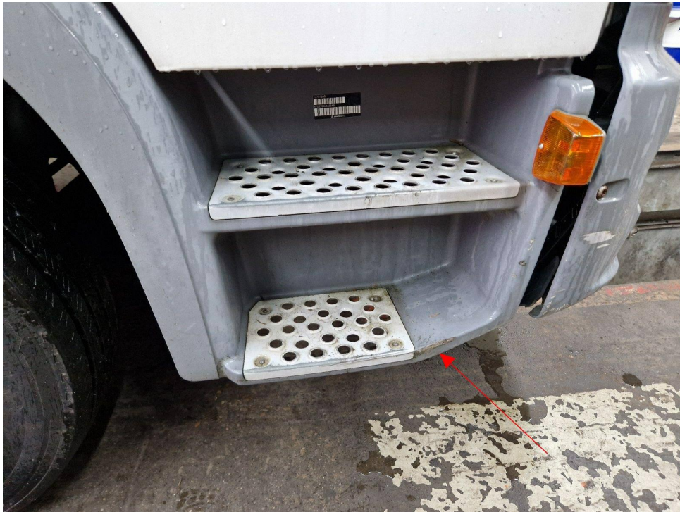
Bild 27 : Einstieg rechts unten verschrammt
