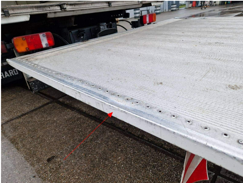
Bild 9 : Ladebordwand Seitenprofil links eingedrückt
