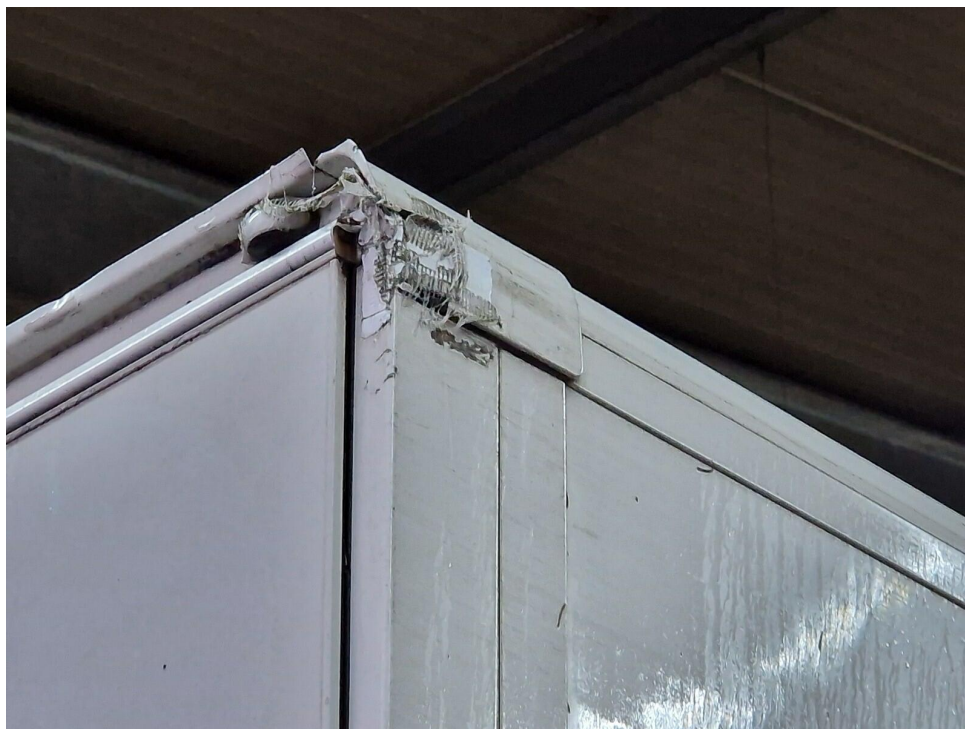
Bild 17 : Kofferaufbau Eckprofil hinten rechts/ Seitenwand eingedrückt
