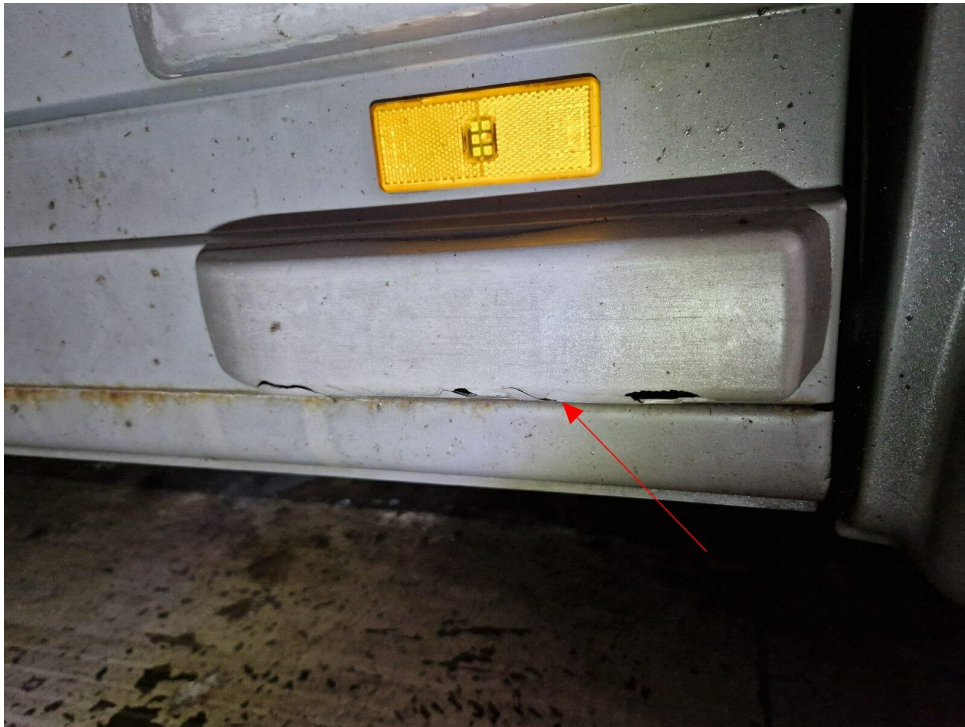
Bild 11 : Seitenverkleidung links gebrochen
