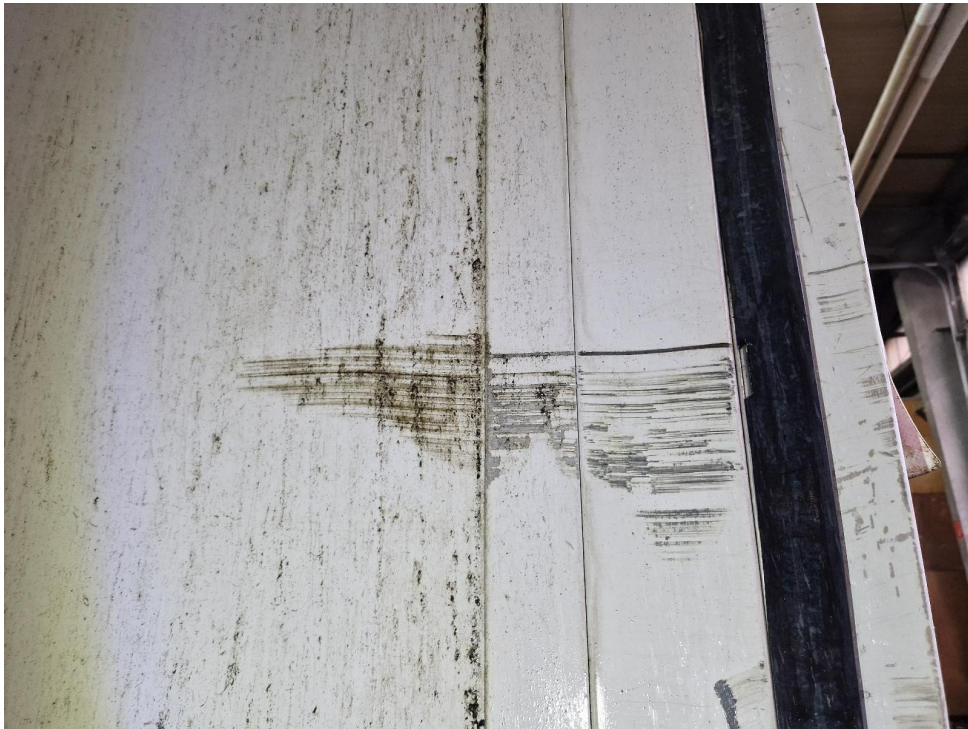
Bild 15 : Kofferaufbau Eckprofil hinten links/ Seitenwand link verschrammt
