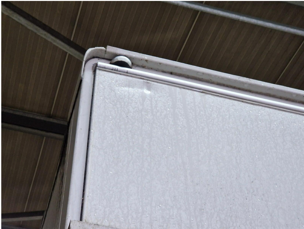
Bild 19 : Klappe Laderaumabschluss eingedrückt
