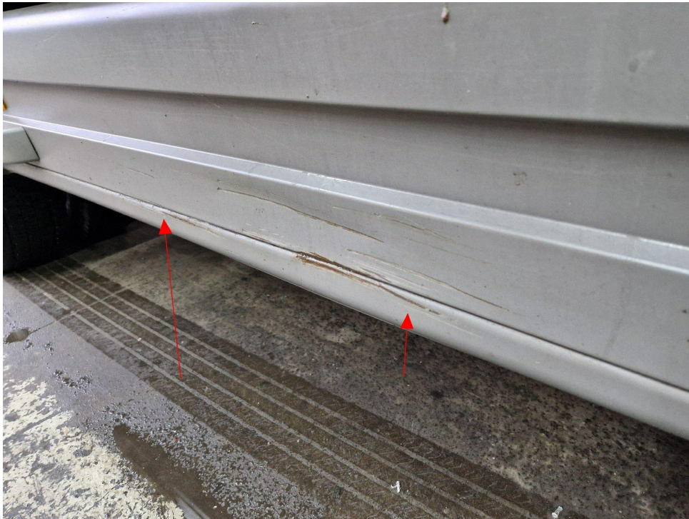
Bild 21 : Seitenverkleidung rechts mehrfach eingedrückt/ verschrammt
