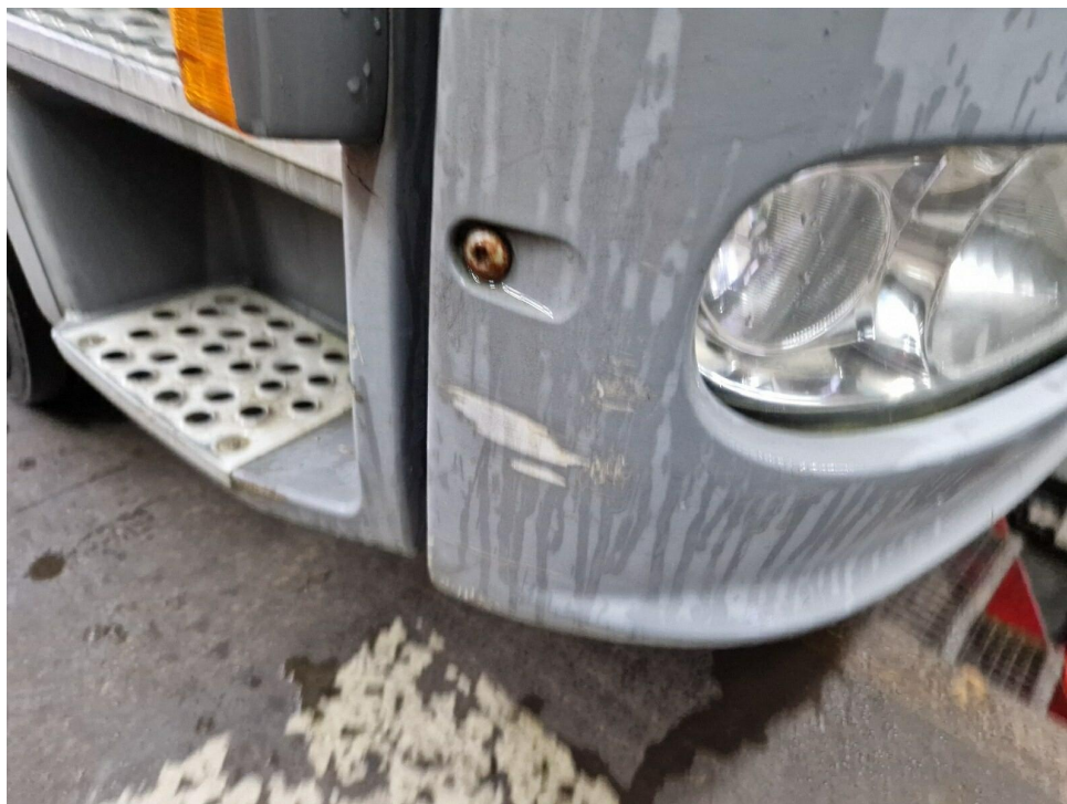
Bild 26 : Stoßecke vorne rechts verschrammt
