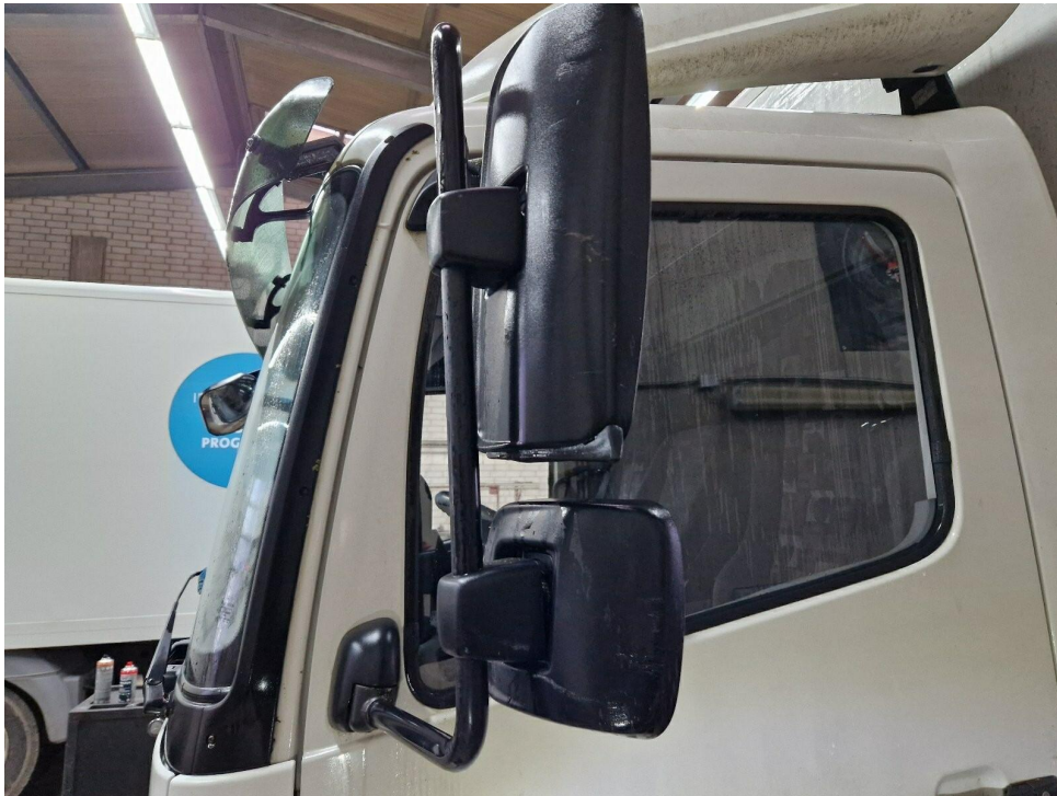
Bild 31 : ASP links verschrammt
