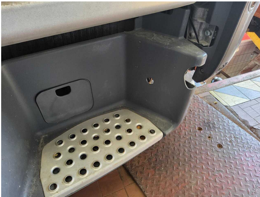
Bild 33 Aufbau Auftritt mittig gebrochen
