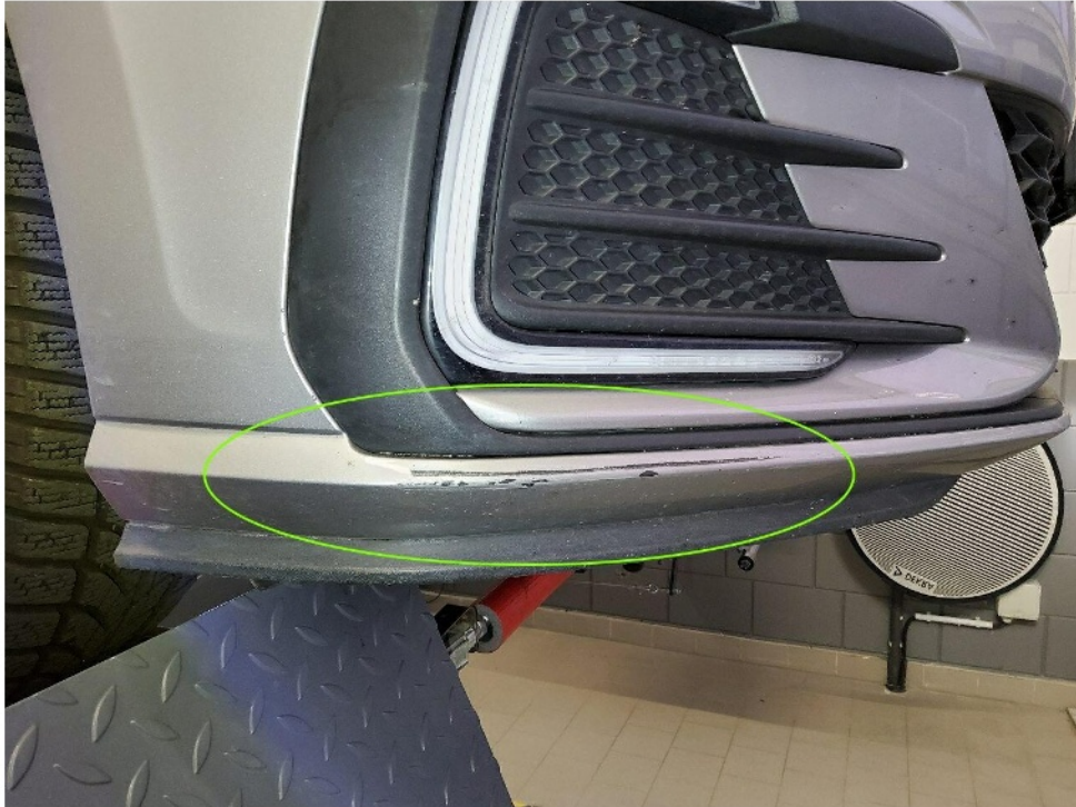
Bild 15 : Stoßfänger vorne rechts verschrammt
