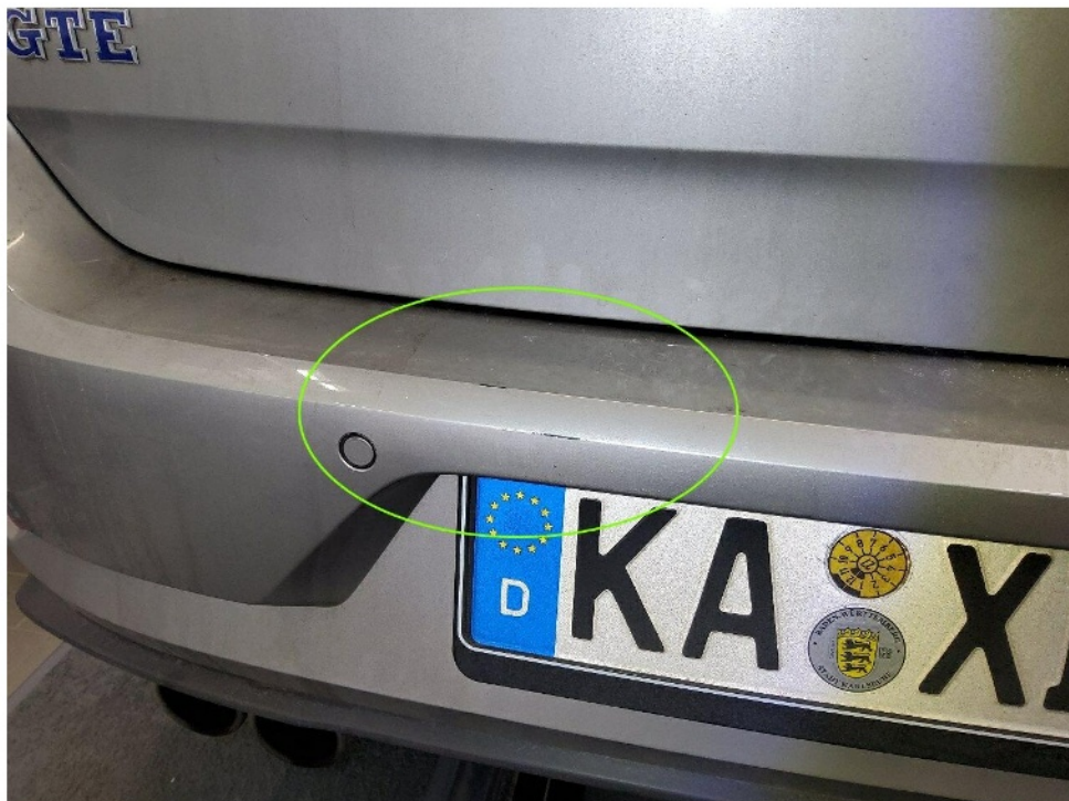
Bild 10 : Stoßfänger hinten, Ladekante mehrfach verschrammt
