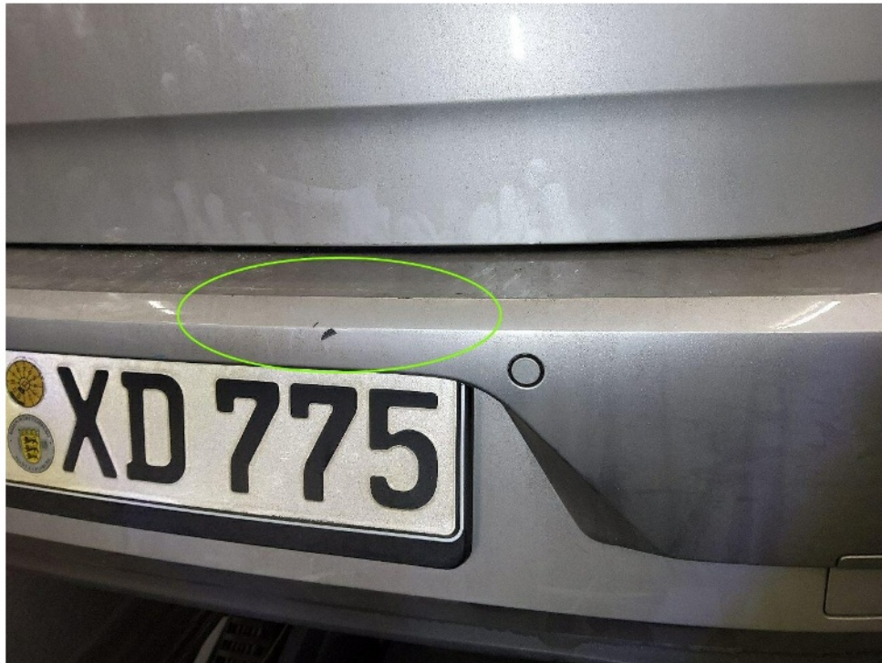
Bild 9 : Stoßfänger hinten, Ladekante mehrfach verschrammt
