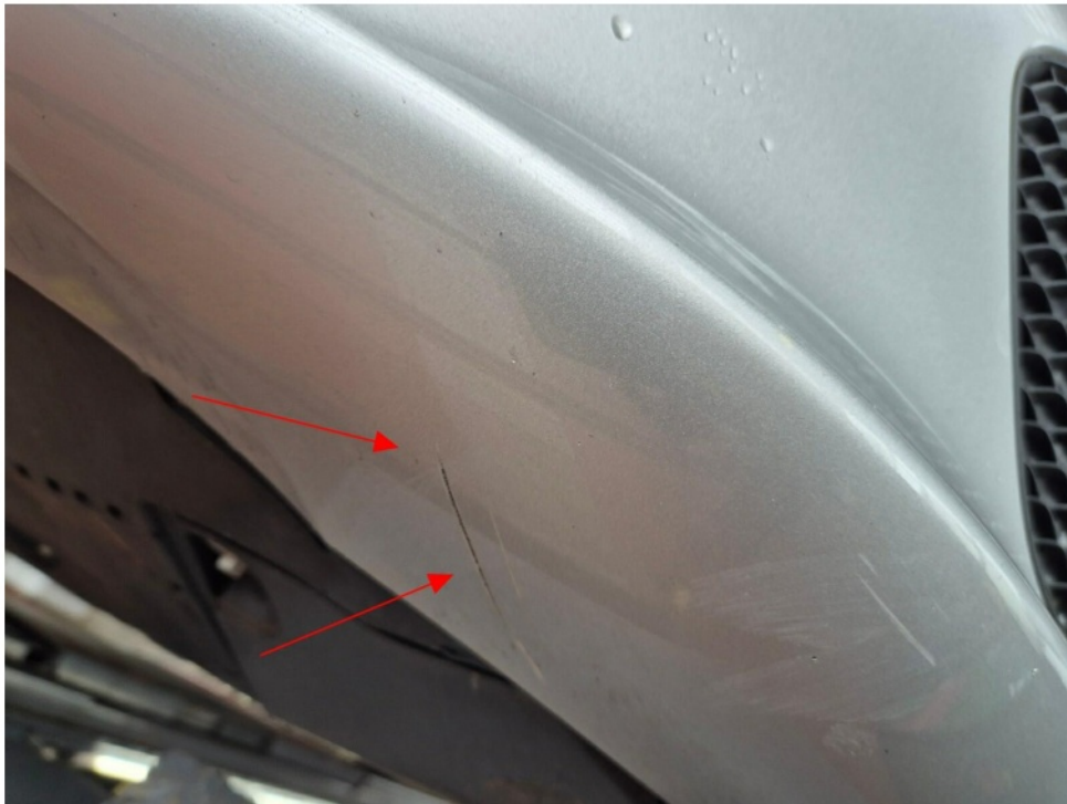
Bild 5 : Frontspoiler Lackierung, zerkratzt, Gebrauchsspur
