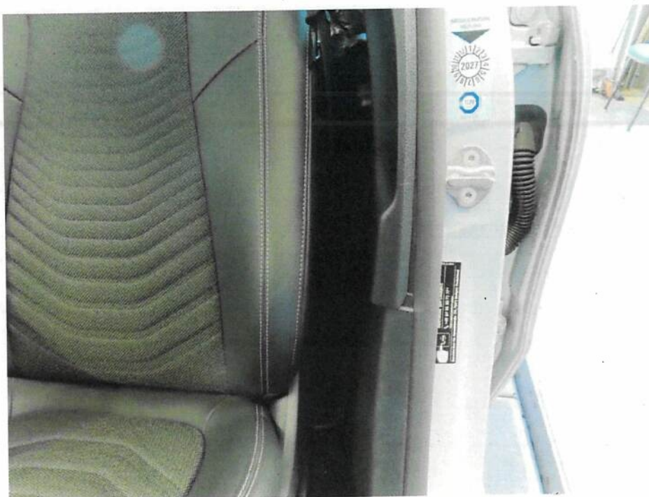
Bild 9 : B-Säulenverkleidung oben links gebrochen
