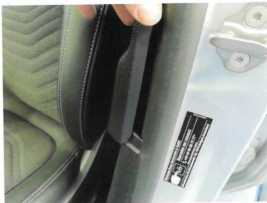
Bild 10 : B-Säulenverkleidung oben links gebrochen
