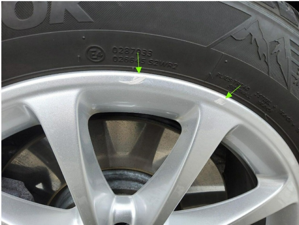
Bild 7 : Felge vorne links, verschrammt, smart repair (Winterrad)
