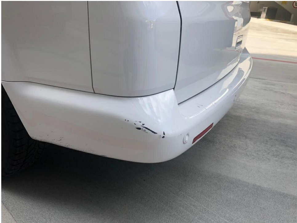
Bild 12 : Stoßfänger hinten mehrfach Anstöße und verschrammt
