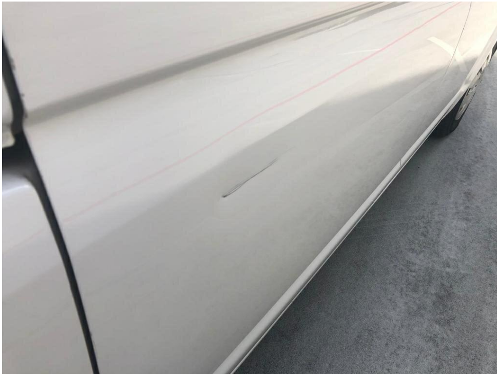
Bild 7 : Schiebetüre rechts tiefer Kratzer
