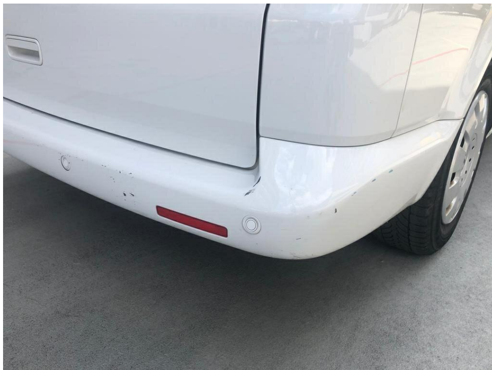
Bild 11 : Stoßfänger hinten mehrfach Anstöße und verschrammt
