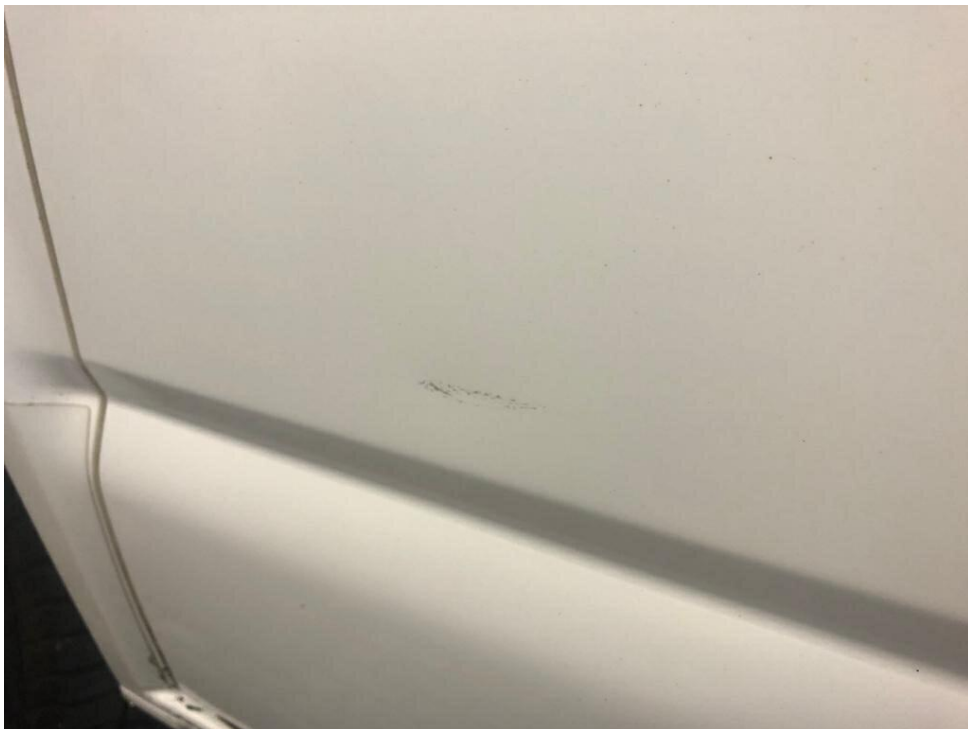
Bild 6 : Schiebetüre rechts tiefer Kratzer
