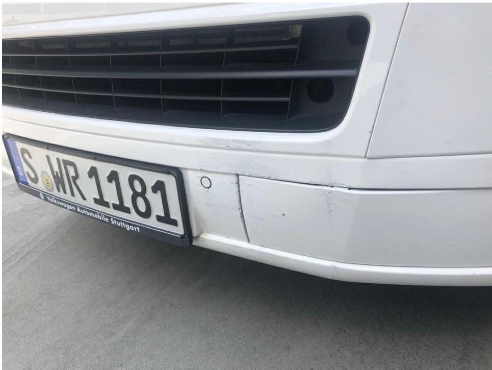
Bild 13 : Stoßfänger vorne verschrammt und deformiert
