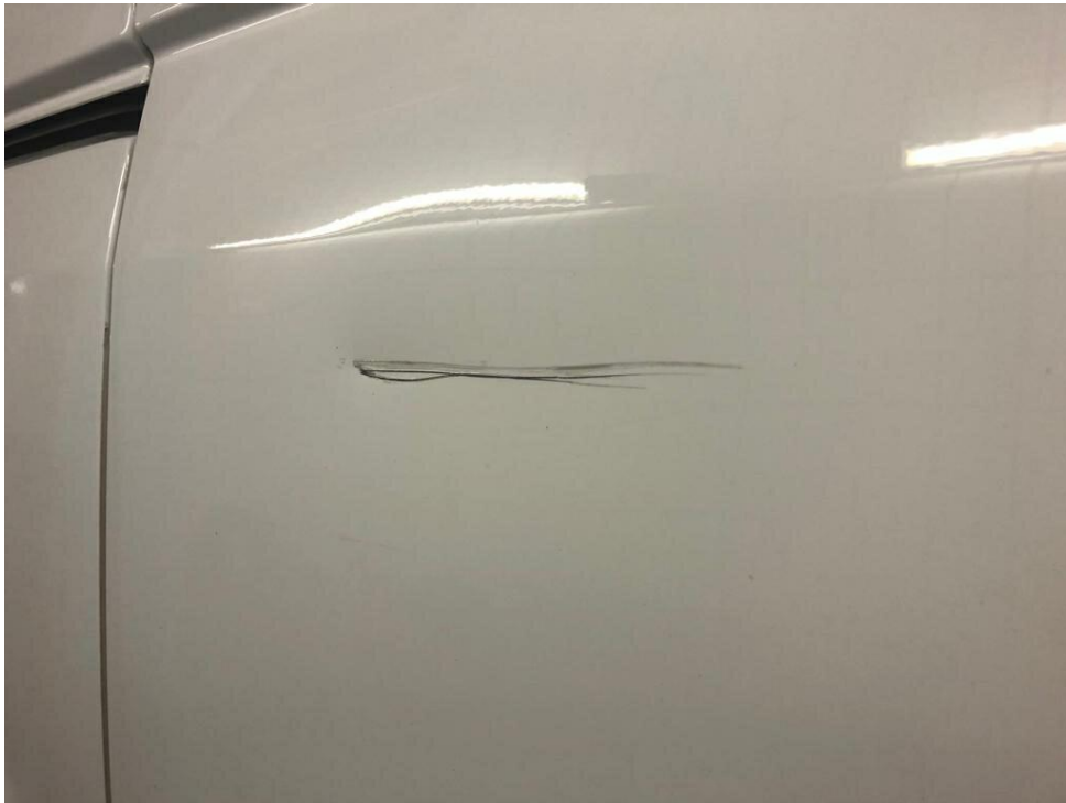
Bild 5 : Seitenteil hinten links tiefer Kratzer
