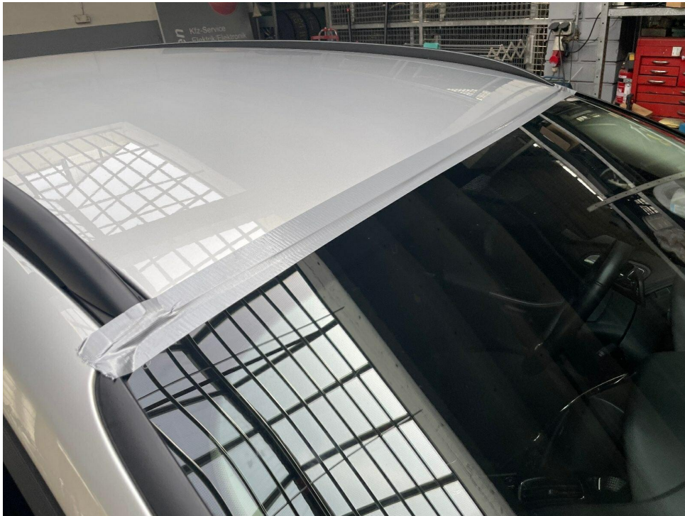
Bild 6 : Windschutzscheibe oben lose - neu einkleben
