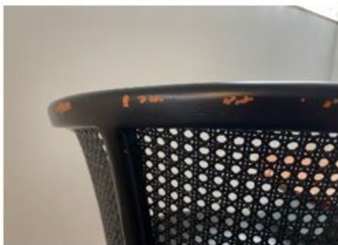
Starke Lackabplatzungen auf Stuhlrückseite
