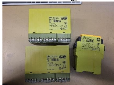
pilz PNOZ X2.8P Sicherheitsrelais, pilz PNOW 4X.1P 24- 240VAC/DC 4n/o, pilz PNOZ 3 230V V AC 6S1Ö
