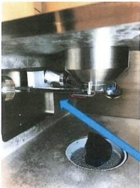
reparierter BSE Detektor in der Vakuumkammer
