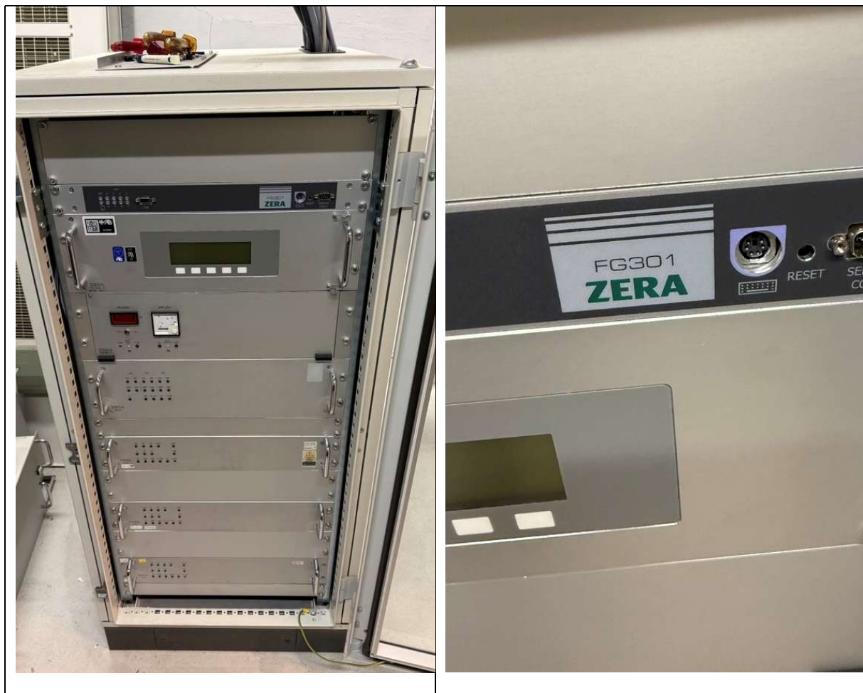
Versorgungsschrank mit Frequenzgenerator, Prüfvähler, Spannungs- und Stromverstärker
