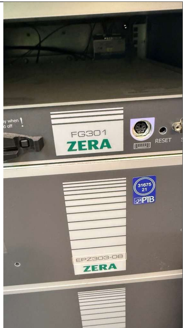
Versorgungsschrank mit Frequenzgenerator, Prüfzähler, Spannungs- und Stromverstärker
