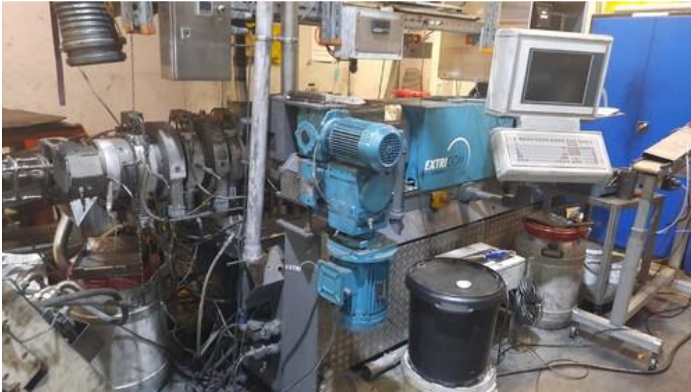
Sidefeeder DSB 040 SFVS inkl. höhenverstellbares Gestell, Drehstromantrieb 3 kW, BJ. 2003
