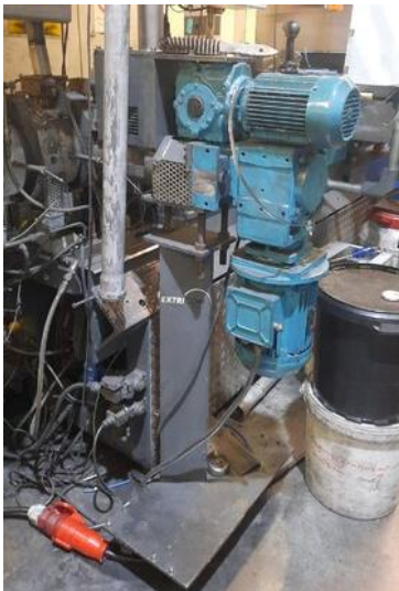
Sidefeeder DSB 040 SFVS inkl. höhenverstellbares Gestell, Drehstromantrieb 3 kW, BJ. 2003
