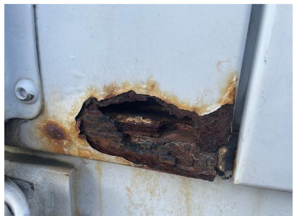
Bild 6: Tür links Korrosion - instandsetzen
