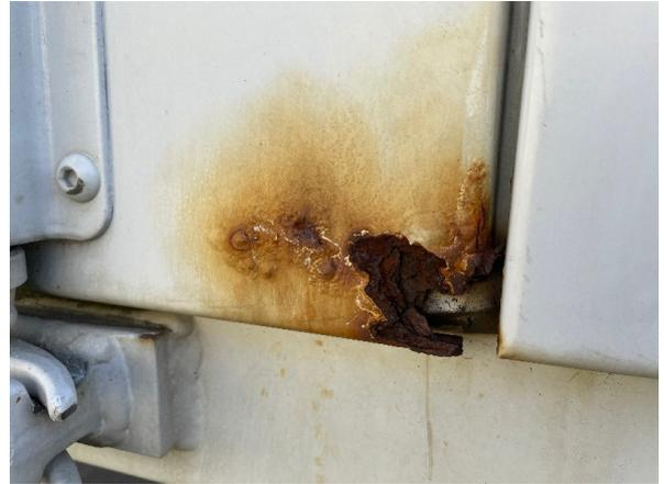
Bild 8: Tür links durchgerostet - instandsetzen und lackieren
