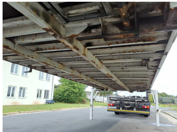
Gebrauchsspur 1: Karosserie: Karosserie - Korrosion - kein Abzug
