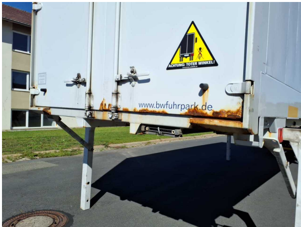
Beschädigung 1: Karosserie: Karosserie - Korrosion - instandsetzen und lackieren
