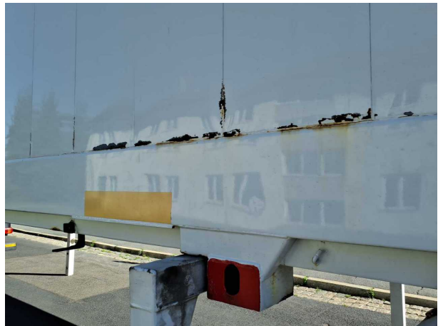
Beschädigung 1: Karosserie: Karosserie - Korrosion - instandsetzen und lackieren
