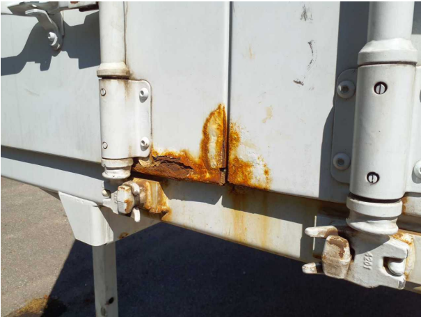
Gebrauchsspur 1: Karosserie: Karosserie - Korrosion - kein Abzug
