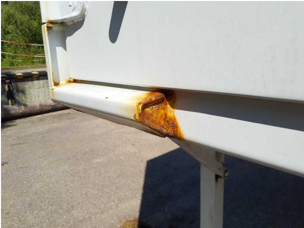
Gebrauchsspur 1: Karosserie: Karosserie - Korrosion - kein Abzug
