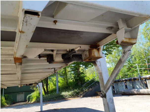
Gebrauchsspur 1: Karosserie: Karosserie - Korrosion - kein Abzug
