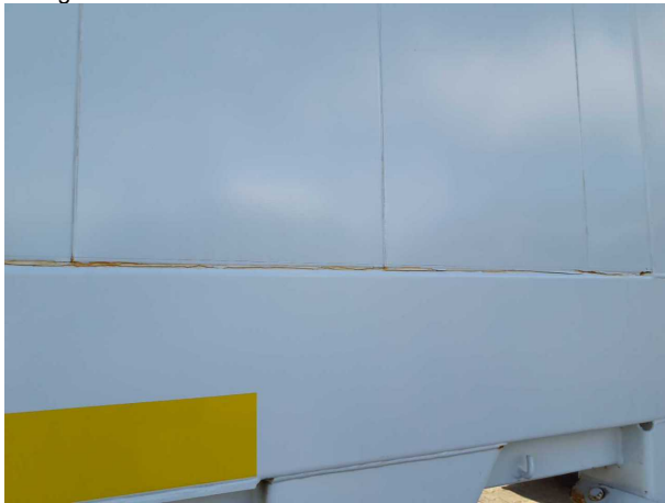
Gebrauchsspur 1: Karosserie: Karosserie - beschädigt - kein Abzug
