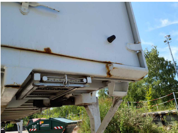
Gebrauchsspur 1: Karosserie: Karosserie - Korrosion - kein Abzug
