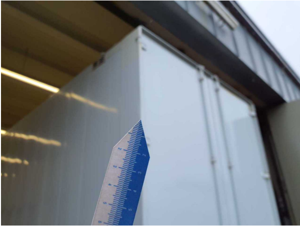
Beschädigung 1: Seitenwand links: Seitenwand - verformt - instandsetzen und lackieren
