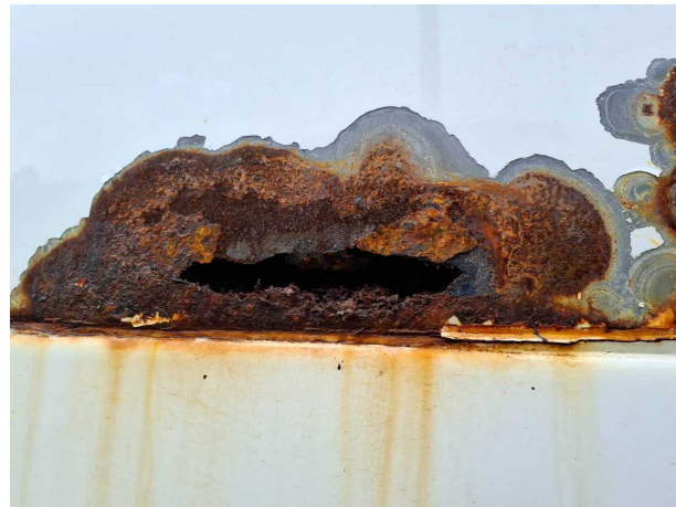
Beschädigung 2: Karosserie: Karosserie - Korrosion - instandsetzen und lackieren
