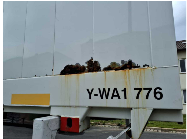
Beschädigung 2: Karosserie: Karosserie - Korrosion - instandsetzen und lackieren
