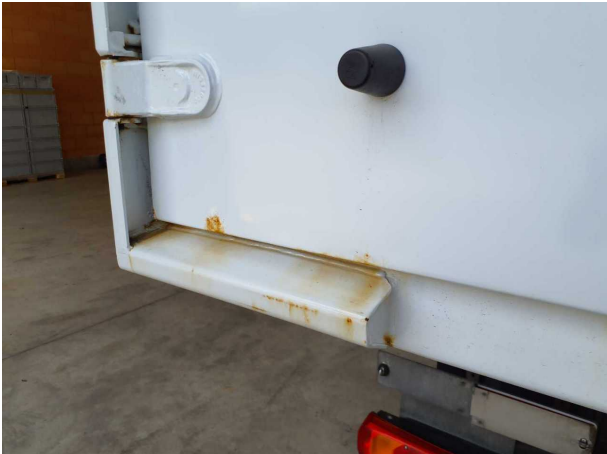
Gebrauchsspur 1: Karosserie: Karosserie - Korrosion - kein Abzug
