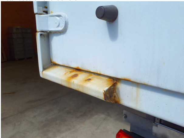
Gebrauchsspur 1: Karosserie: Karosserie - Korrosion - kein Abzug
