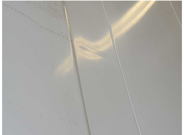
Beschädigung 1: Seitenwand rechts: Seitenwand - beschäd... - instandsetzen und lackieren
