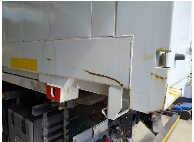
Gebrauchsspur 1: Karosserie: Karosserie - Korrosion - kein Abzug
