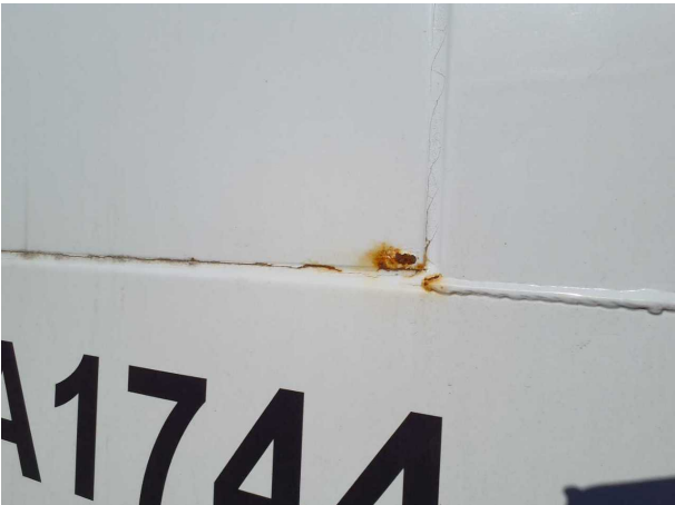
Gebrauchsspur 1: Karosserie: Karosserie - Korrosion - kein Abzug
