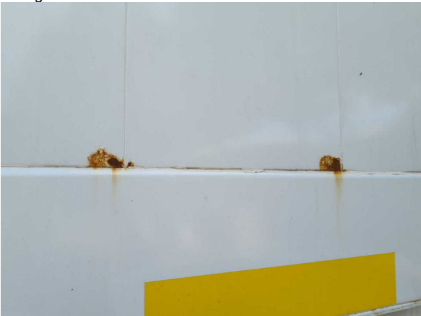
Gebrauchsspur 1: Karosserie: Karosserie - Korrosion - kein Abzug
