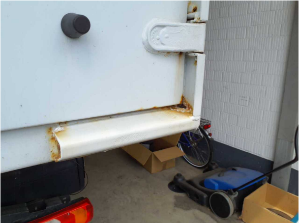
Gebrauchsspur 1: Karosserie: Karosserie - Korrosion - kein Abzug
